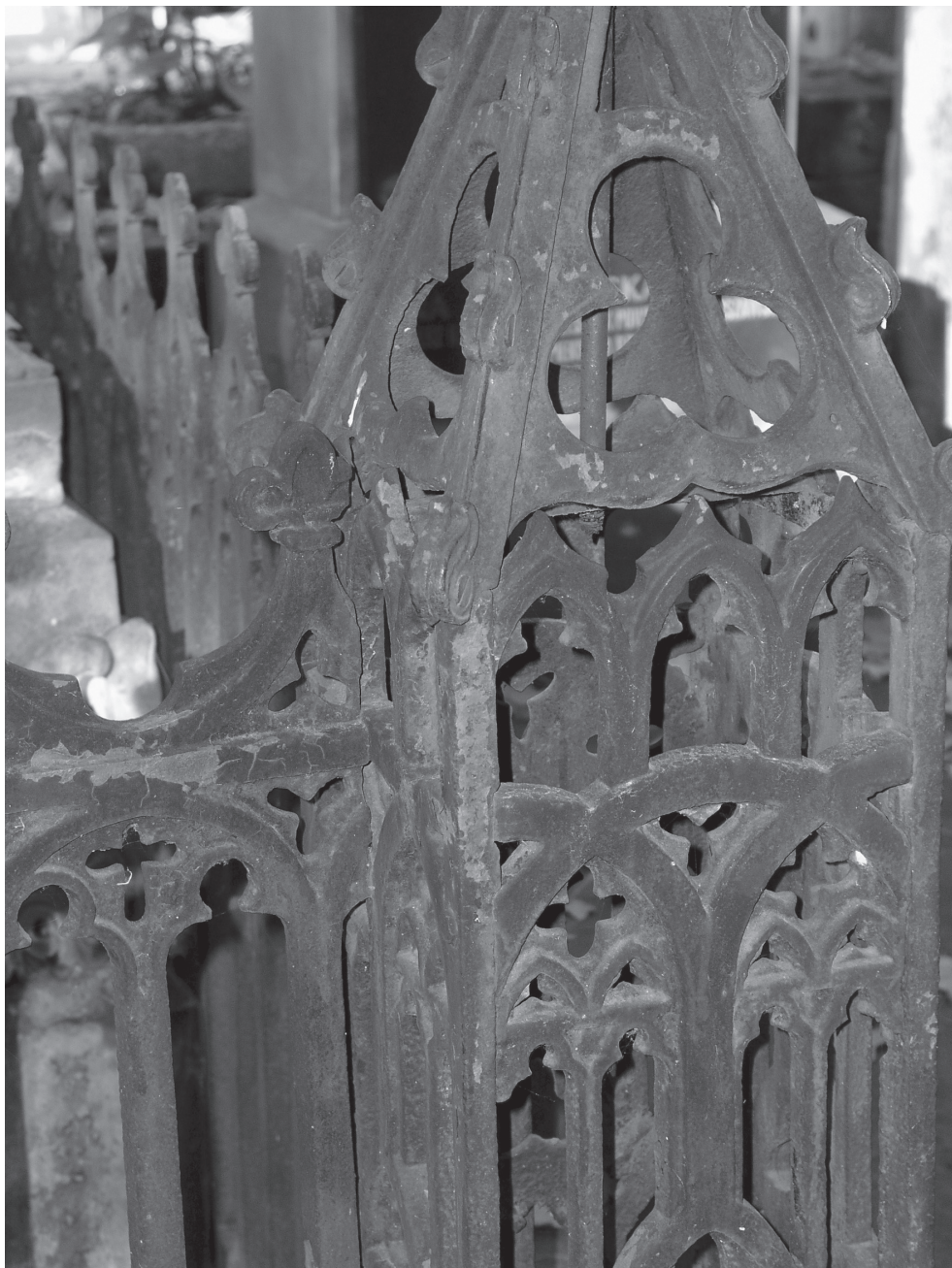
21. Żelazo ma zasadniczą wadę – nie jest odporne na chemiczne oddziaływanie otaczającej atmosfery; już w zwykłym powietrzu pokrywa się warstwą tlenków (rdzy), która nie stanowi bariery ochronnej przed dalszą penetracją gazowych składników powietrza, głównie tlenu. Fot. S. Safarzyński
