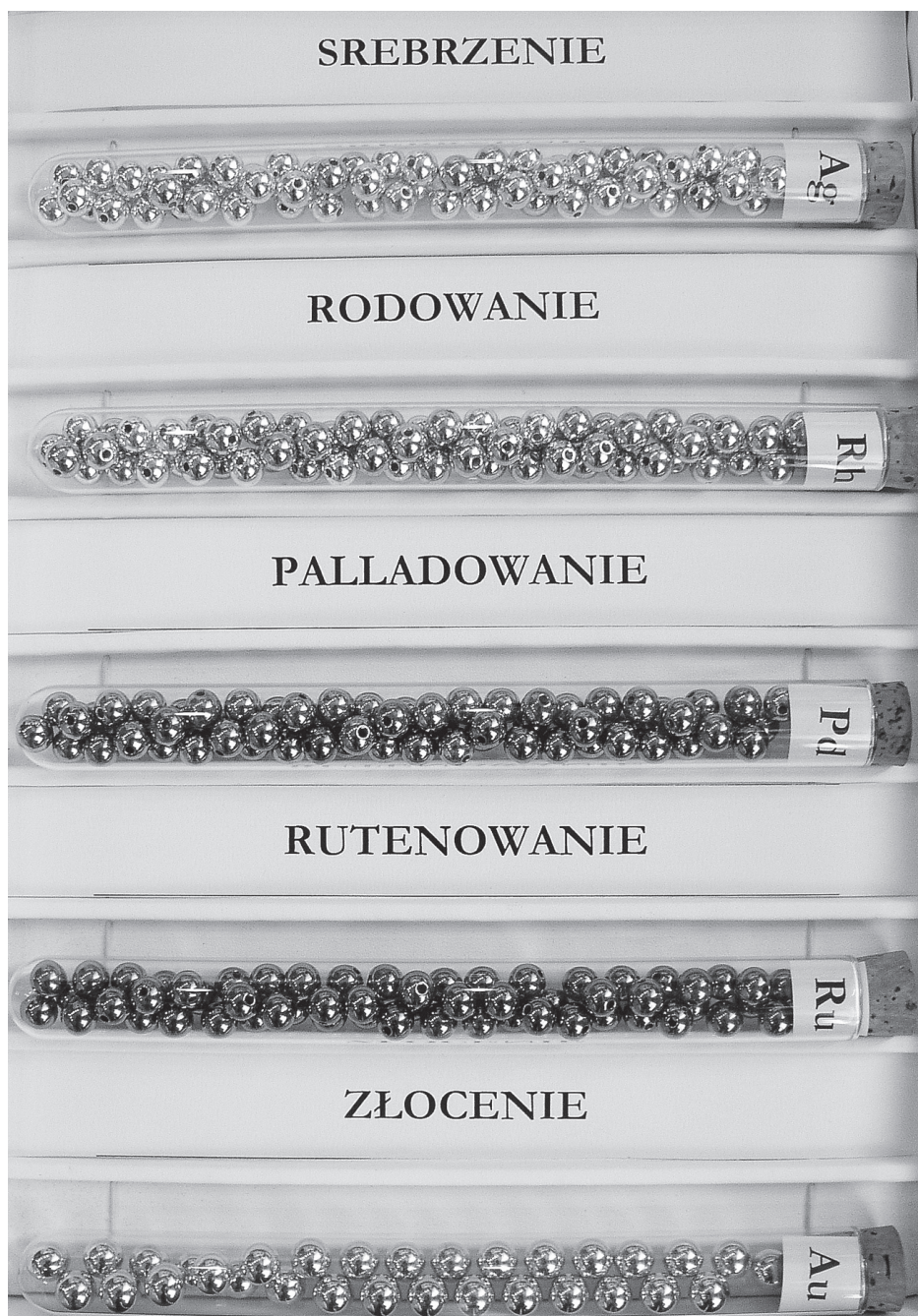
26. W celu ochrony srebra przed ciemnieniem osadza się niekiedy na powierzchni przedmiotów z tego metalu powłoki z metali szlachetnych. Fot. S. Safarzyński
