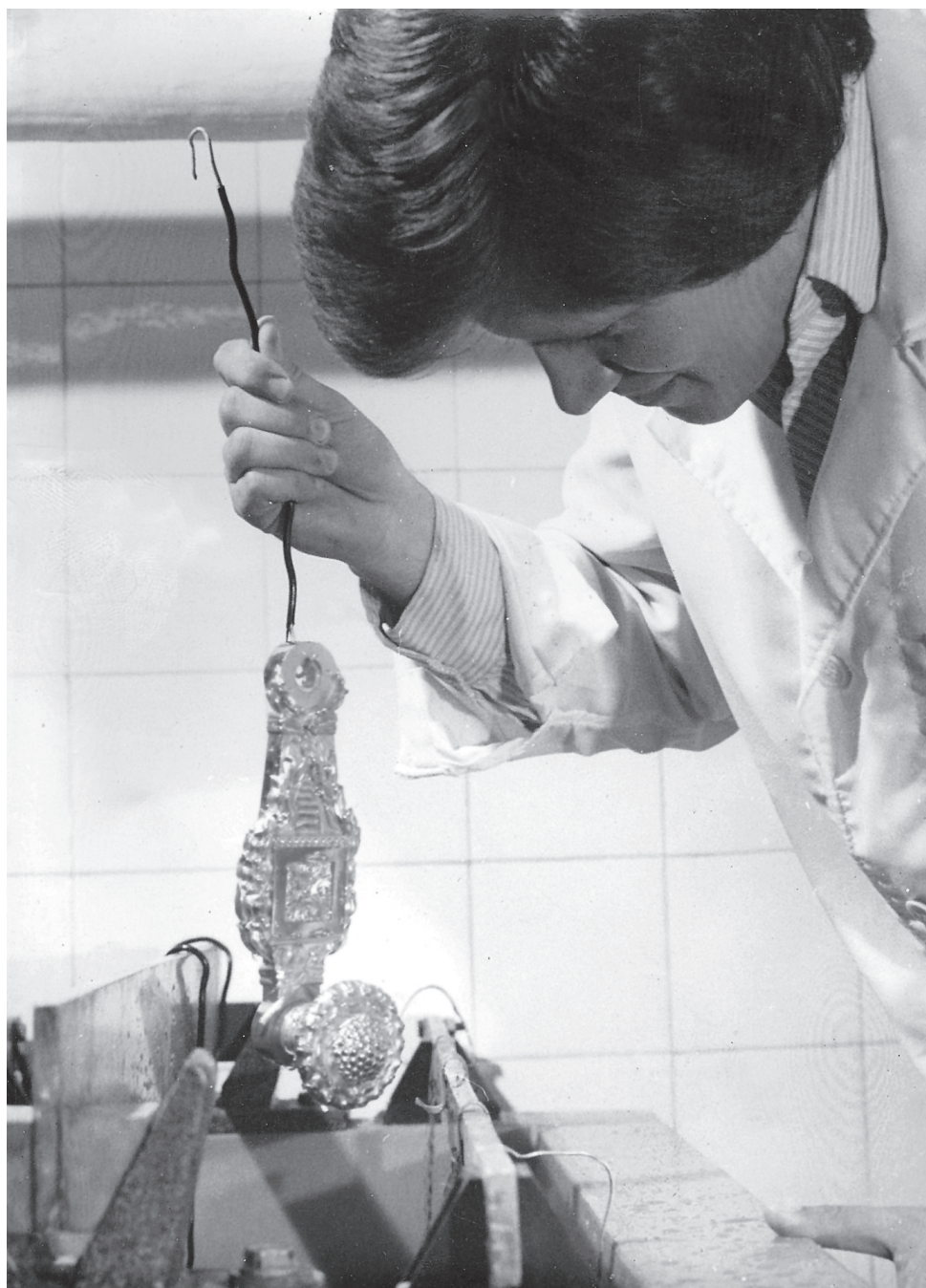
12. Galwaniczne złocenie okuć okiennych wykonanych z brązu. Fot. J. Skowroński
