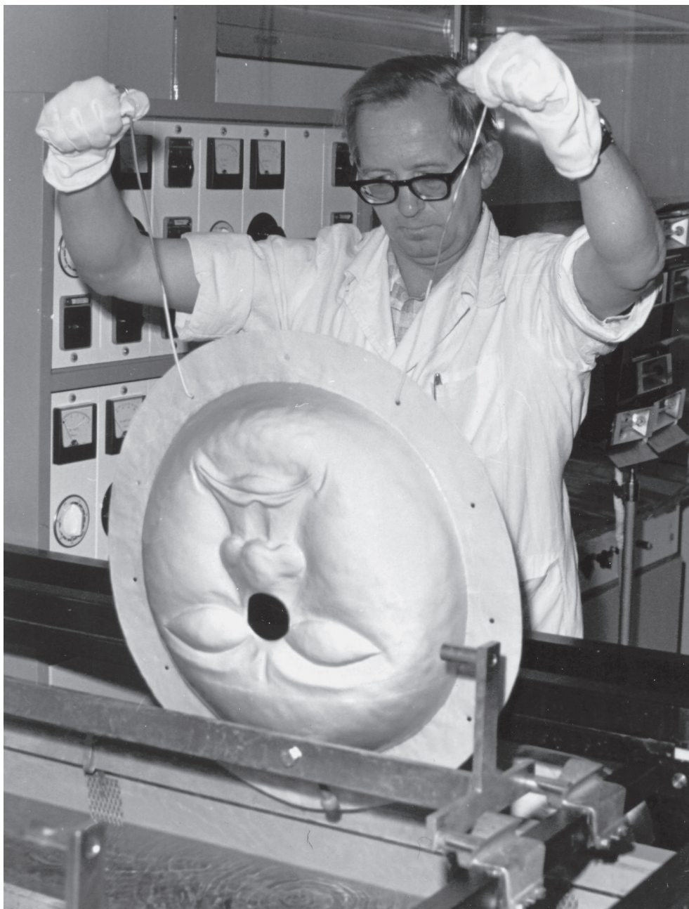
4. Warstwy złote osadzone w roku 1974 metodą galwaniczną bezpośrednio na miedzianych elementach zewnętrznego wystroju architektonicznego Zamku Królewskiego w Warszawie. Ich grubość (25-30 mikrometrów) zapewniała bowiem całkowitą szczelność tych pokryć. Fot. J. Skowroński
