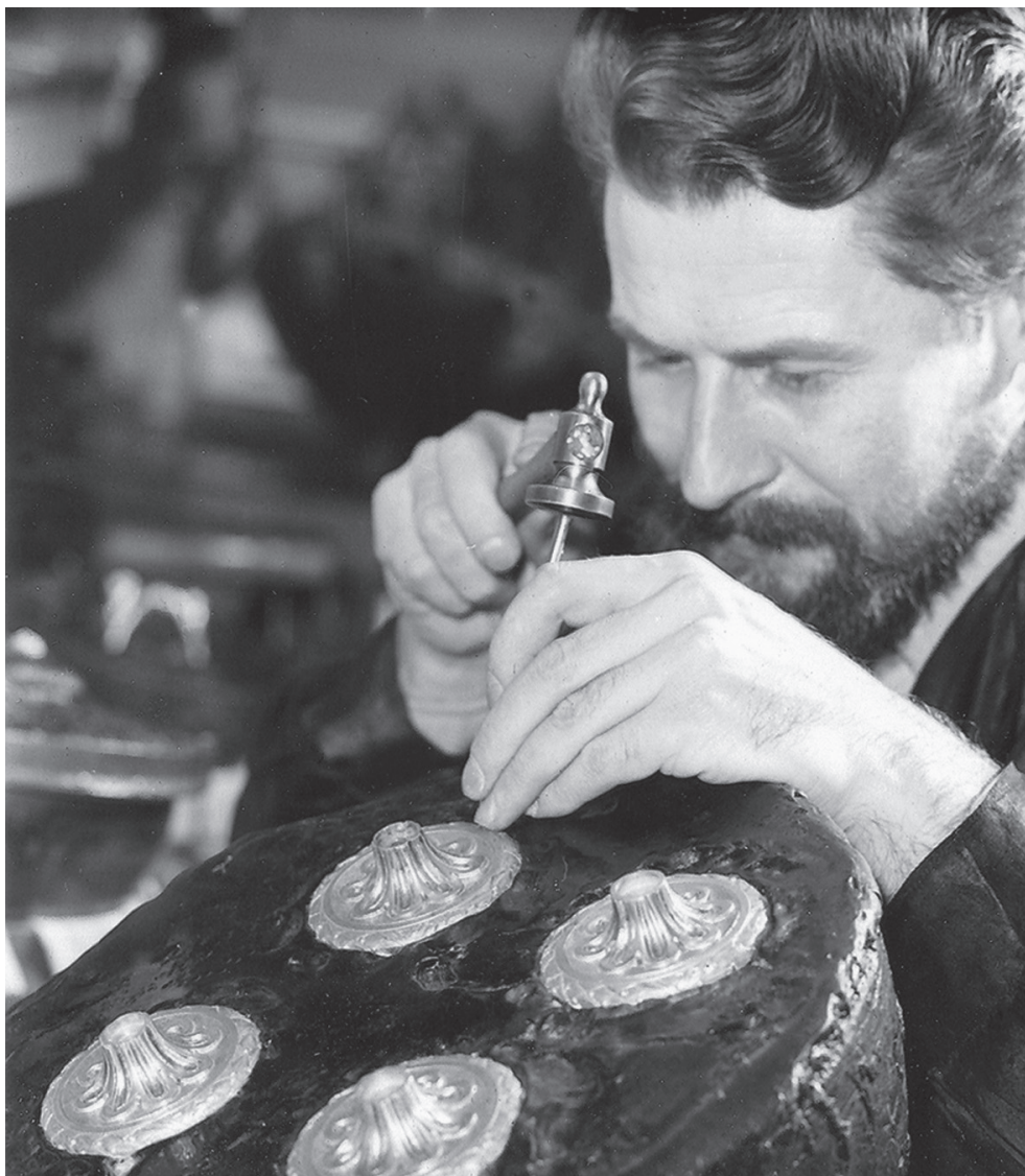
6. Technika cyzelerska polega na dokładnym, mechanicznym opracowaniu powierzchni obiektu, na ogół odlanego z brązu. Fot. archiwum KAW
