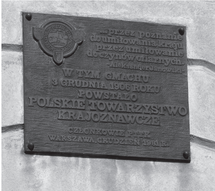
20. Przykład wadliwie wytworzonej warstewki konwersyjnej na tablicy wykonanej z brązu. Fot. S. Safarzyński
