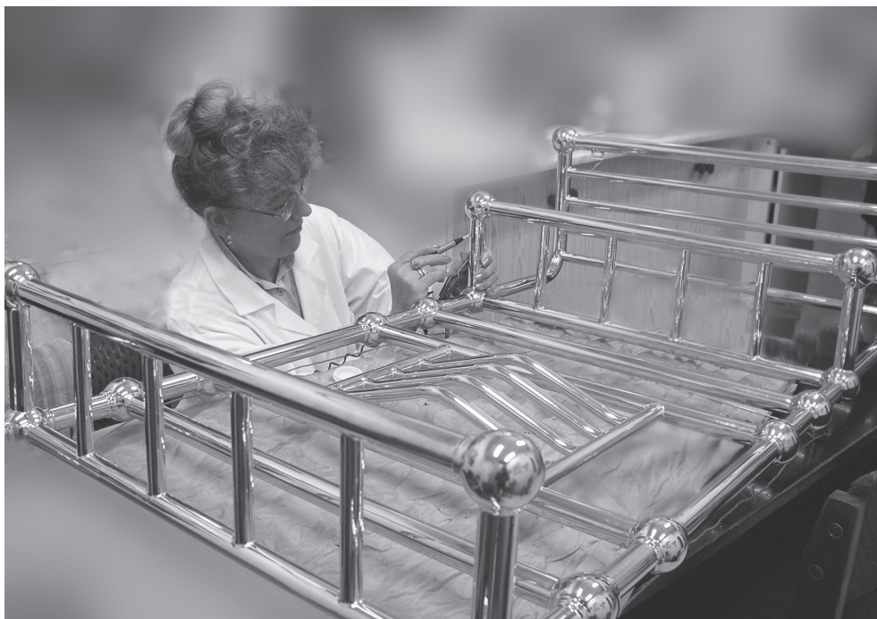
14. Naprawa miejsc niepokrytych warstwą złota. Fot. S. Safarzyński
