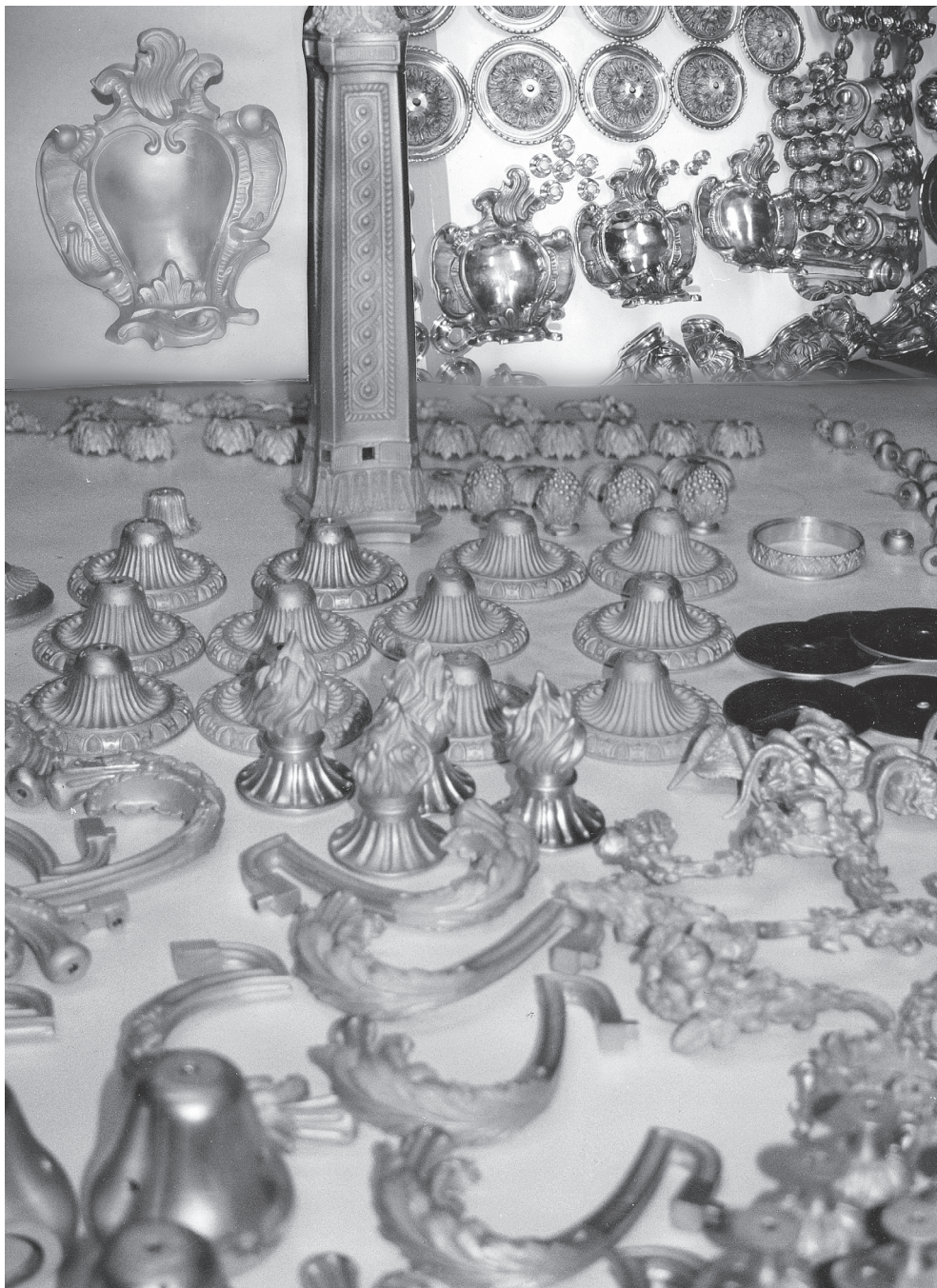
14. Otrzymywane metodą ogniową powłoki złote były półbłyszczące. Fot. S. Safarzyński
