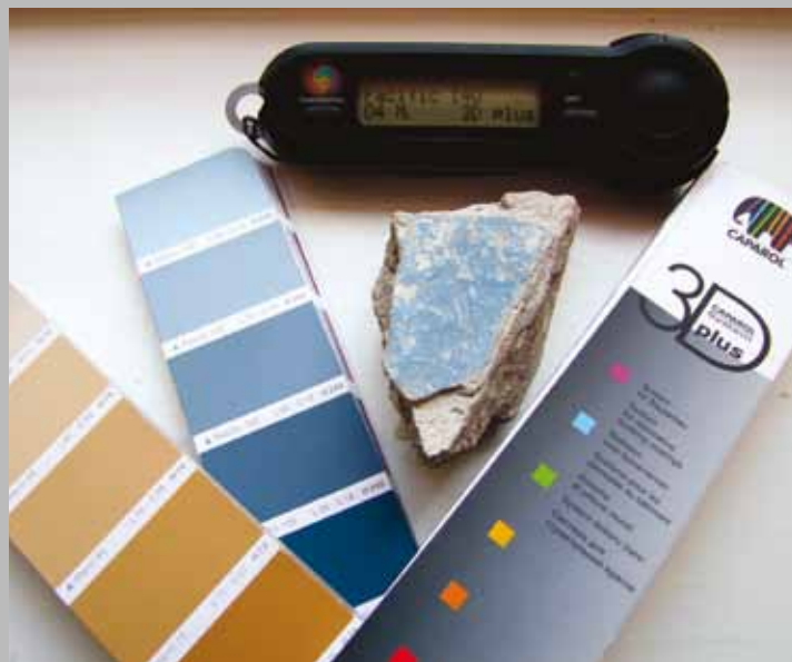
3. Fragment tynku pochodzącego ze sklepienia kościoła z dobrze zachowanym pierwotnym wymalowaniem – nad nim kolorymtr elektroniczny z wyświetlonym wynikiem badania, a wokół wachlarzowy wzornik kolorów firmy Caparol z odnalezionym odwzorowaniem barwy (Pacific 140)
