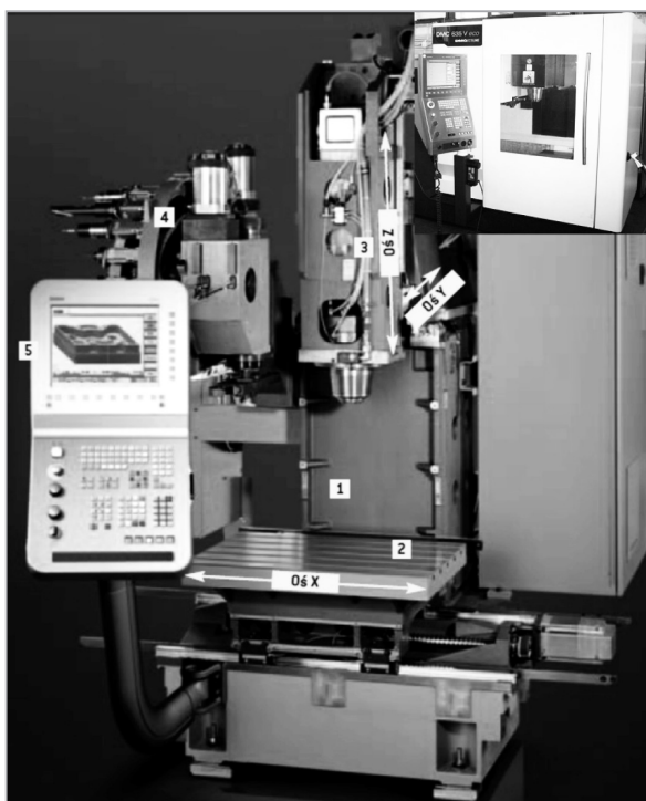
Rys. 1.1. Centrum frezarskie DMC 65 V (3 osie): 1 – korpus żeliwny, 2 – stół roboczy, 3 – wrzeciono, 4 – magazyn narzędziowy, 5 – panel sterowania
