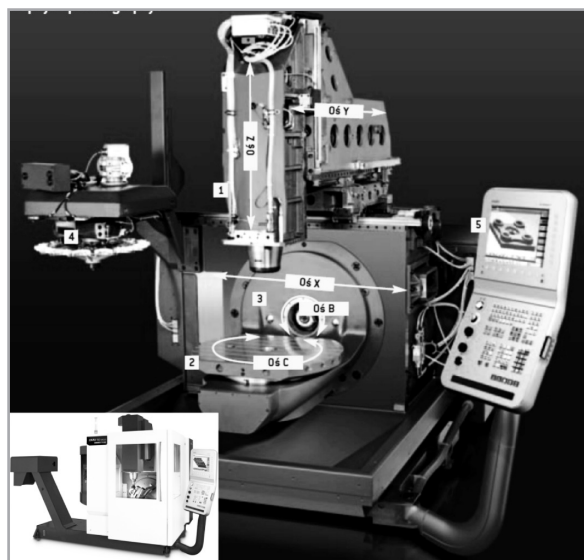
Rys. 1.2. Centrum frezarskie DMU 50 eco (5 osi): 1 – wrzeciono, 2 – stół uchylny-obrotowy, 3 – przestrzeń robocza, 4 – magazyn narzędziowy, 5 – panel sterowania
