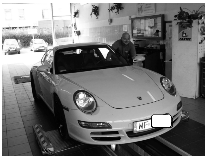
Rys. 7.9. Urządzenie do wymuszania szarpnięć kołami.
