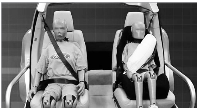
Rys. 6.8. Działanie poduszki pasa bezpieczeństwa
