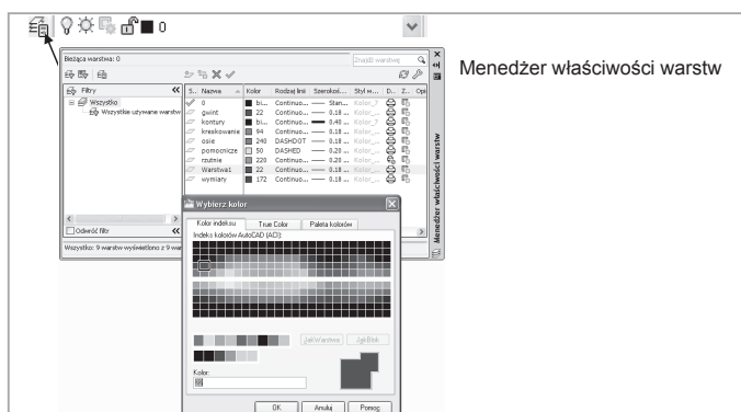
Rys. V.6.1.1. Przykładowy układ warstw rysunkowych
