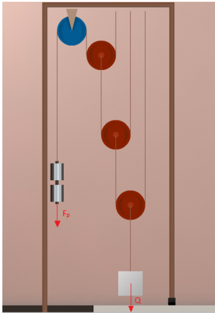
Rysunek 4.2. Schemat wielokrążków potęgowych.
