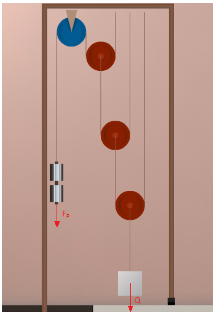
Rysunek 4.2. Schemat wielokrążków potęgowych.
