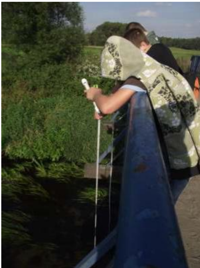
Pomiar głębokości rzeki Głuszynka i prędkości przepływu wody.
