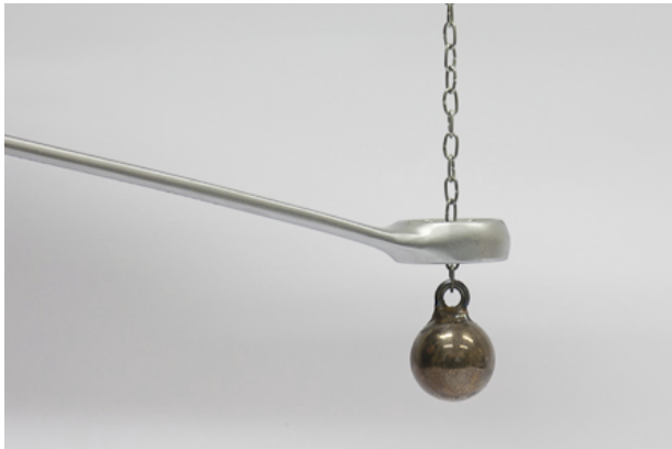
Rysunek 8.1. Klucz oczkowy z kulką w temperaturze pokojowej
