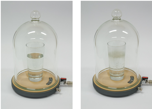
Rysunek 11.5. Szklanka z wodą o temperaturze pokojowej umieszczona pod kloszem pompy próżniowej: pod ciśnieniem atmosferycznym oraz przy obniżonym ciśnieniu
