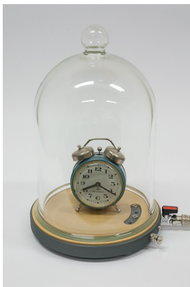
Rysunek 11.6. Budzik umieszczony pod kloszem pompy próżniowej
