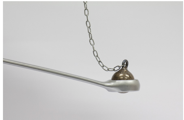
Rysunek 8.2. Klucz oczkowy z kulką ogrzaną za pomocą palnika do wyższej temperatury
