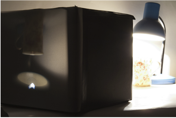
Rysunek 19.2. Obraz źródła światła i oświetlonego przedmiotu — kubka otrzymany przy użyciu „aparatu”
