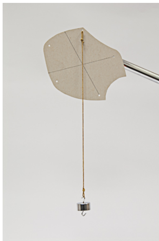
Rysunek 1.1. Wyznaczanie środka masy figury płaskiej
