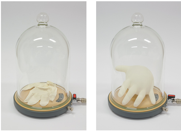
Rysunek 11.2. Gumowa rękawiczka umieszczona pod kloszem pompy próżniowej: pod ciśnieniem atmosferycznym oraz przy obniżonym ciśnieniu
