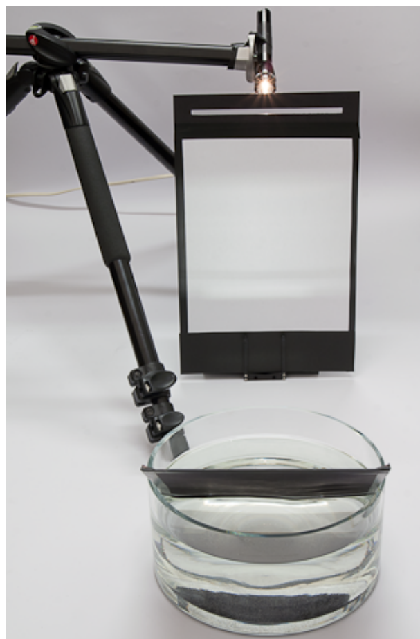
Rysunek 15.1. Układ do obserwacji widma światła „białego”
