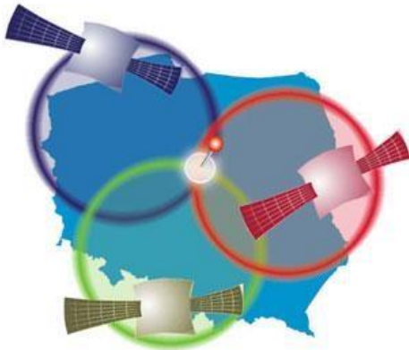
Rysunek 28. Ilustracja lokalizowania za pomocą trzech satelit
