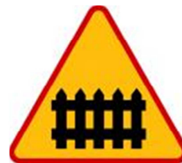
Przejazd kolejowy z zaporami
