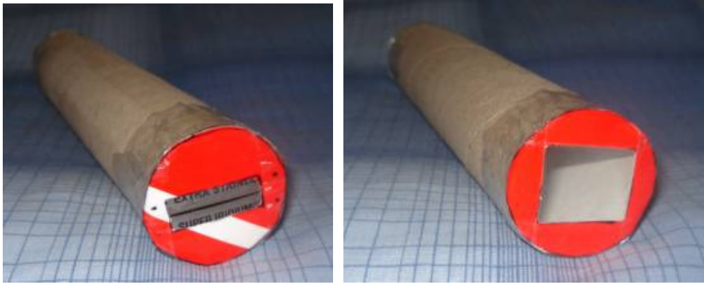
Rysunek 12 Gotowy spektroskop z widokiem na szczelinę wykonaną z żyletki (po lewo) oraz z widokiem na siatkę dyfrakcyjną (po prawo).
