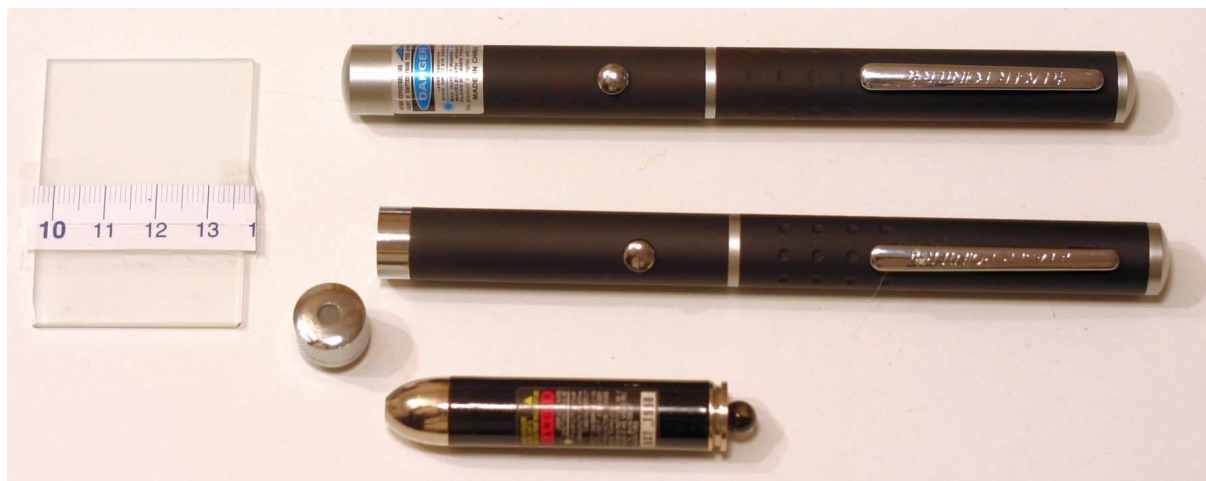
Zdjęcie matówki z naklejoną skalą i trzech wskaźników laserowych.
