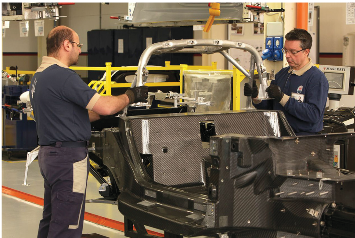
# 17. Struktura nadwozia Alfy Romeo 4C przypomina tę stosowaną w Formule 1.
