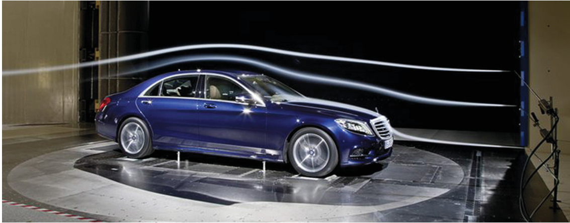
# 20. Strugi powietrza w tunelu aerodynamicznym. Warto zwrócić uwagę na idealną formę linii środkowej.
