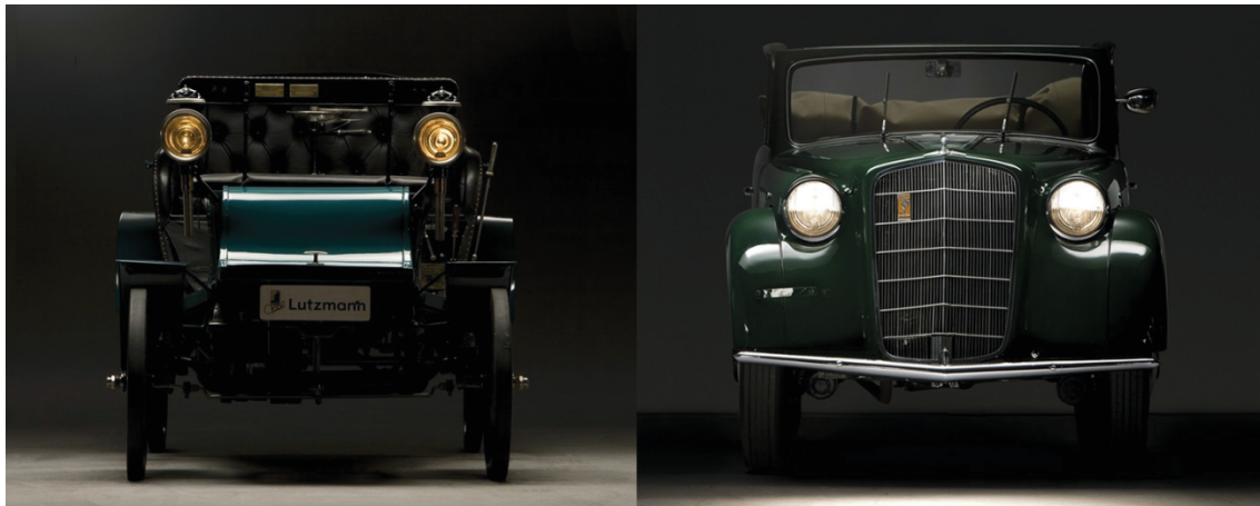
# 64. Przełom w oświetleniu. Z lampy naftowej na oświetlenie elektryczne (Opel Lutzmann i Opel Olympia).
