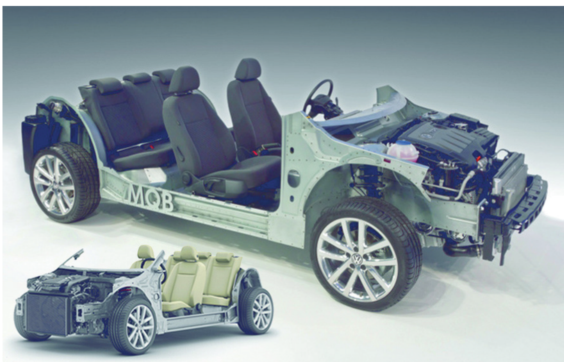
# 8. Platforma MQB. Tak przygotowana platforma posłuży do zbudowania Skody Fabii, Seata Leona, czy Volkswagena Passata.
