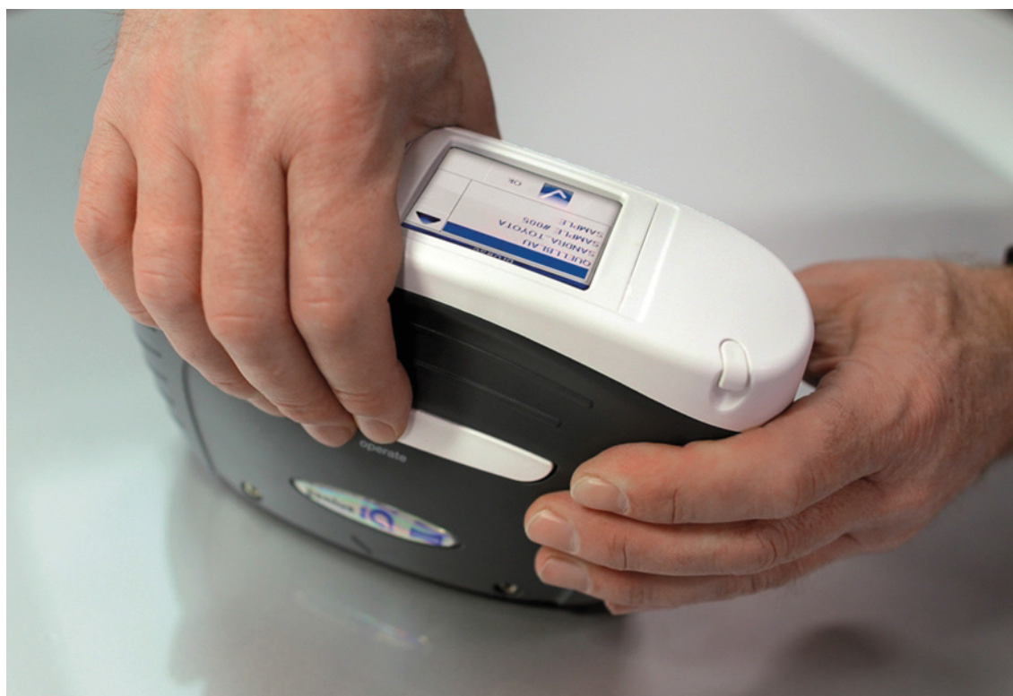
# 32. Spektrofotometr przyłożony do oryginalnego lakieru dokonuje szybkiego pomiaru koloru. Wyniki (w postaci cyfrowej) umożliwiają komputerowy dobór receptury.
