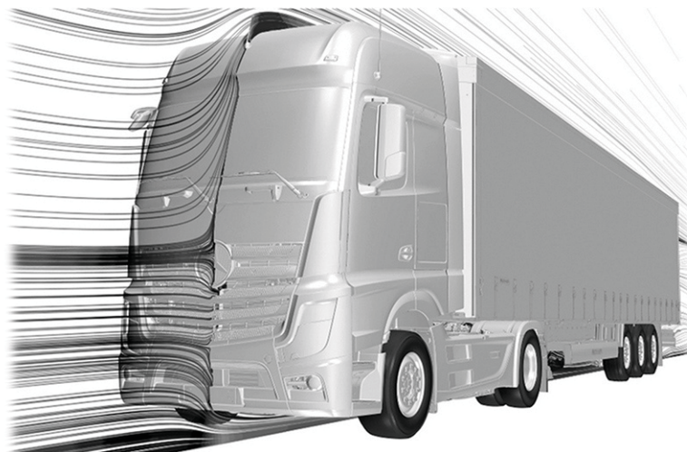
# 62. Zanim wprowadzono na rynek ciężarowy model Actros przez 2600 godzin trwały próby w tunelu aerodynamicznym. W wersji ciężarowej ogromnie ważne jest bowiem prowadzenie strugi pod samochodem, ograniczenie oporu ogromnej płyty czołowej i zagwarantowanie przepływu strugi nad kabiną.
