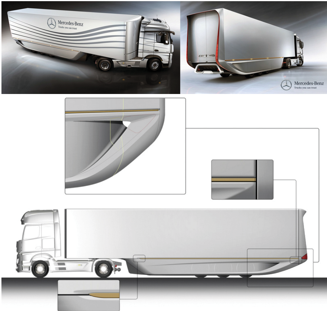
# 63. Drogowy TGV. Zwrócono uwagę na odpowiednie prowadzenie strugi opływającego powietrza w całym zestawie. Stąd, niespotykana dotychczas, zabudowa naczepy.
