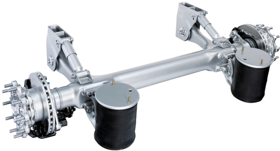
# 61. Oś DCA Airmaster, w której wyeliminowano zbiorniki powietrza do hamulców. Powietrze jest zmagazynowane wewnątrz osi.
