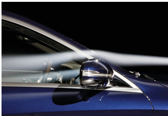
# 25. Podczas prac w tunelu dużą uwagę zwraca się na obudowę lusterka zewnętrznego. Zysk Cx 2-5%.
