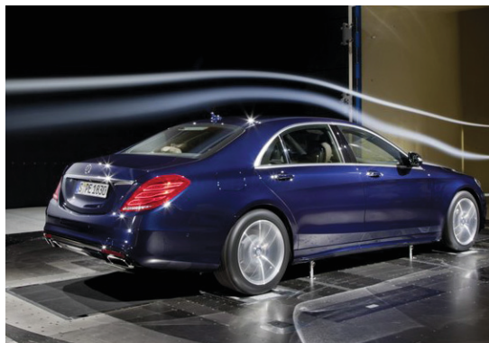
# 26. Karoseria nie powinna tworzyć podciśnienia z tyłu, lecz rozpraszać strugę za pojazdem.
