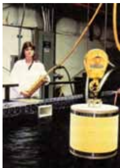
Laboratorium, w którym prowadzi się badania nad radiacyjnym utrwalaniem żywności. Pojemnik z żywnością opuszcza się do basenu zawierający akcelerator wytwarzający promieniowanie. Woda chroni obecnego tu technika przed szkodliwym działaniem promieniowania.
