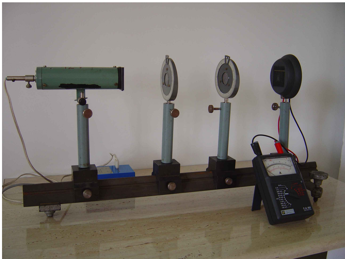
Fot. Zestaw do wyznaczania zależności natężenia wiązki światła, przechodzącego przez układ polaryzator-analizator, od kąta skręcenia polaryzatora
