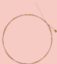
Struny gitarowe z fosfobrazu (Cu, Sn i P).
