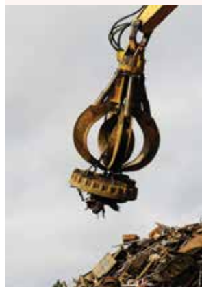
Rozdzielanie złomu za pomocą elektromagnesu.
