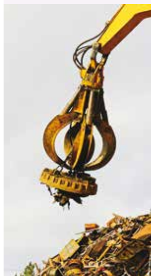
Rozdzielanie żelaznego złomu za pomocą magnesu.
