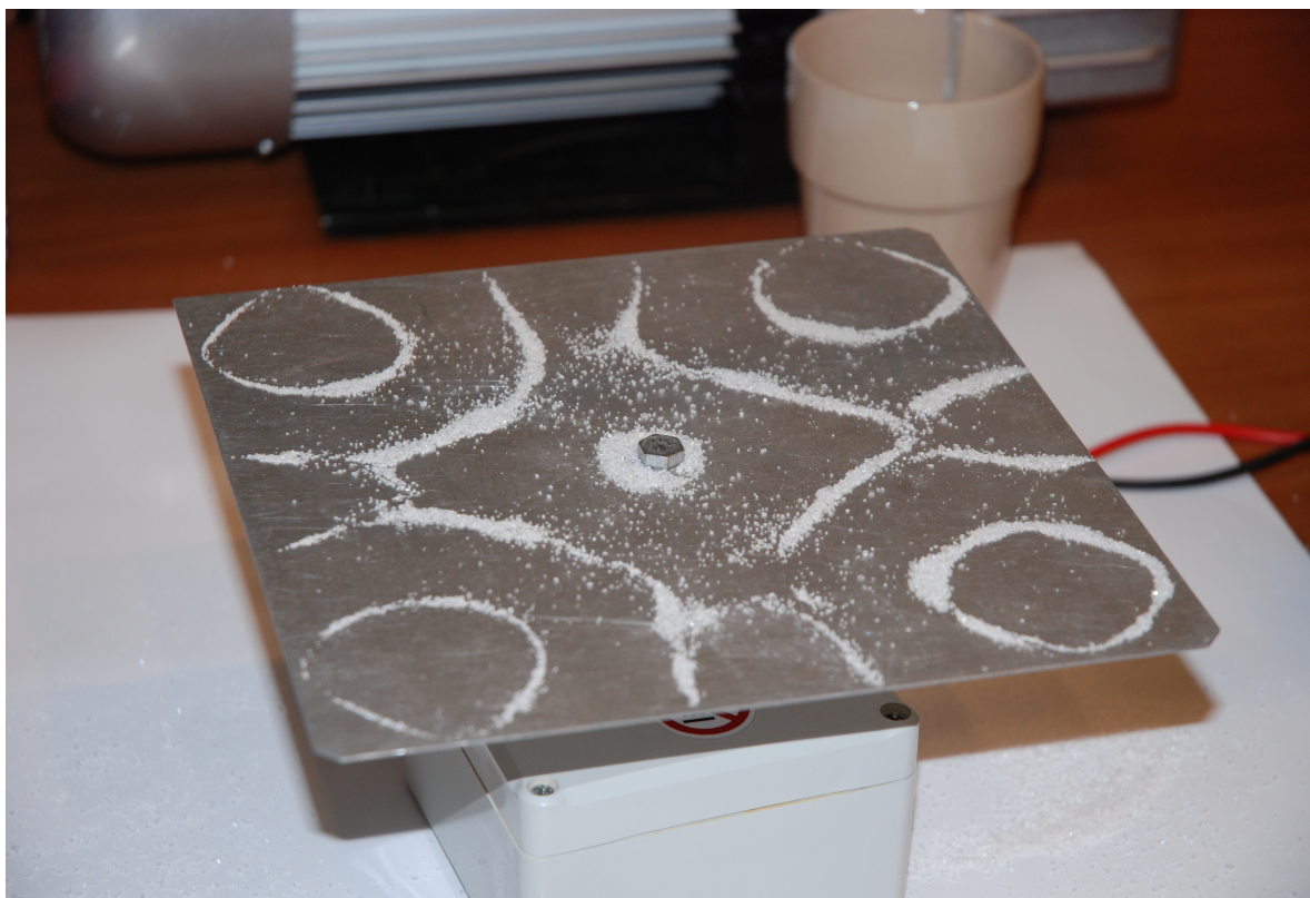
Cukier na drgającej metalowej płycie układa się wzdłuż linii węzłów fali
