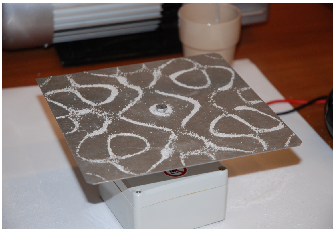
Kształt linii węzłów zmienia się z częstotliwością drgań, przyjmując fantazyjne formy
