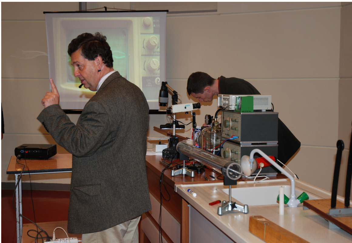
Wnet usłyszymy stojącą fale akustyczną w rurze o regulowanej długości
