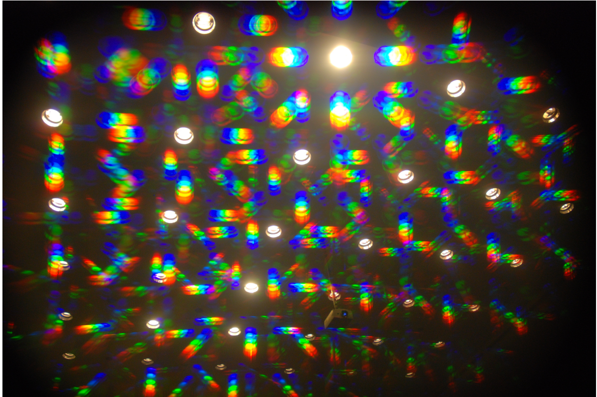
Dyfrakcja i interferencja światła lamp oświetleniowych widzianych przez okulary z siatką dyfrakcyjną
