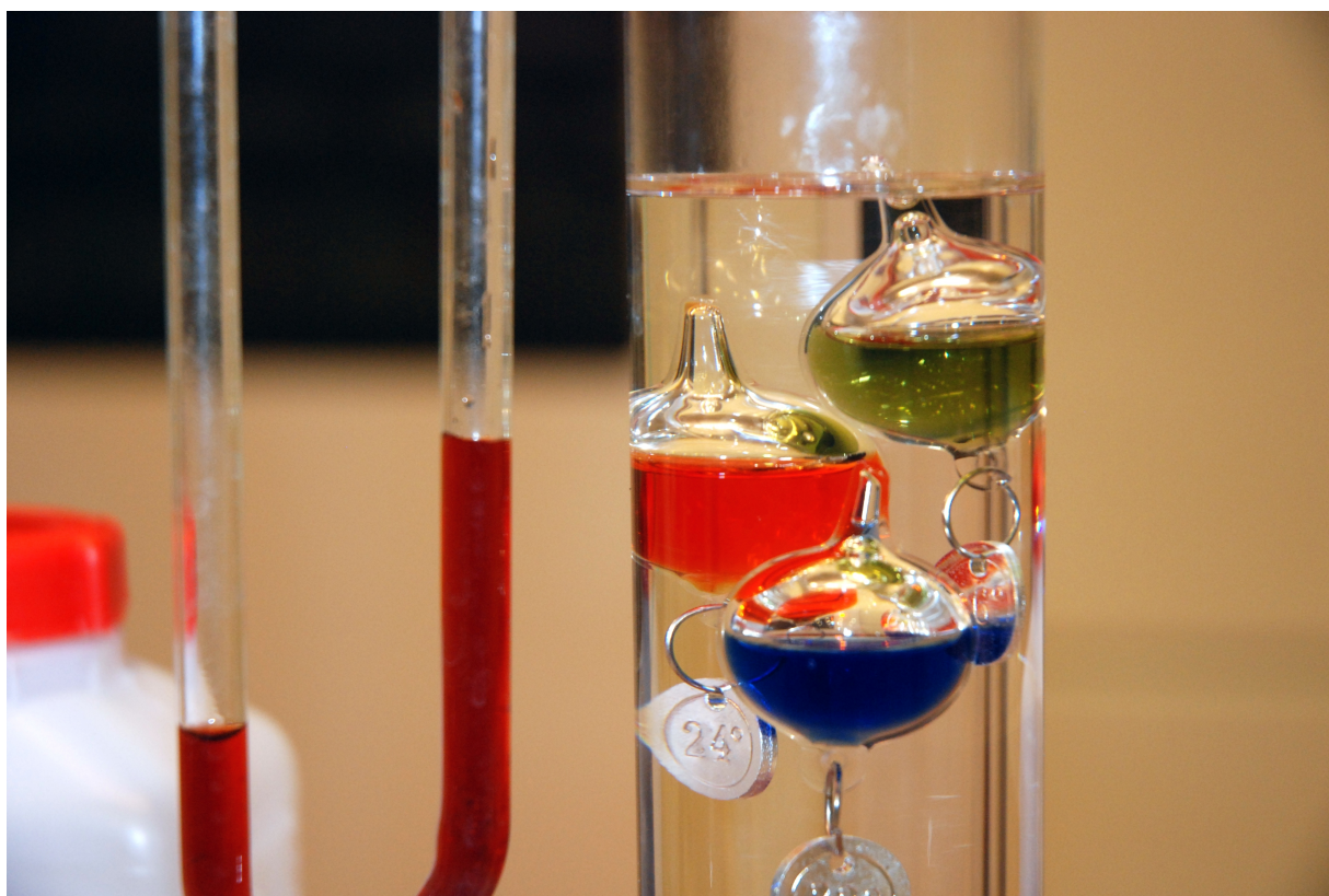
Termometr Galileusza z pływającymi bańkami
