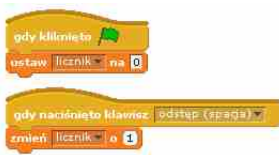
Rys. 51. Program po każdym naciśnięciu klawisza spacji zwiększa wartość zmiennej licznik o 1 i zeruje licznik po kliknięciu zielonej flagi
