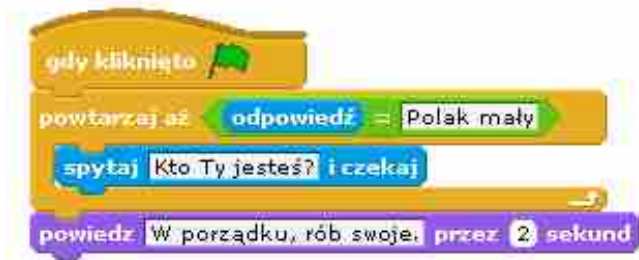
Rys. 40. Pętla "powtarzaj aż..." powoduje wykonywanie instrukcji umieszczonych w jej wnętrzu aż do momentu spełnienia warunku (w tym przypadku wpisania odpowiedzi "Polak mały")
