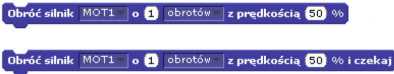
Rys. 74. Te bloczki pozwalają na precyzyjne sterowanie obrotami silnika
