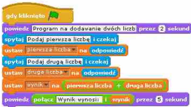
Rys. 50. Program obliczający sumę dwóch liczb
