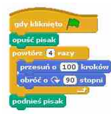
Rys. 53. Program rysujący kwadrat o boku 100
