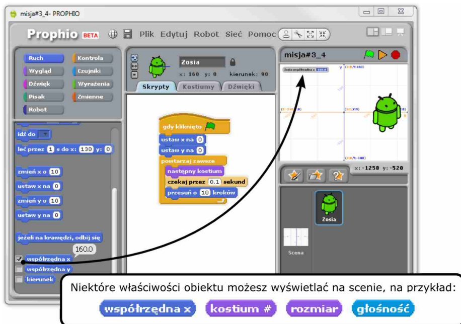
Rys. 26. Wiele właściwości obiektu możesz wyświetlić na scenie, aby sprawdzić ich wartość zaznaczając pole wyboru umieszczone po lewej stronie wybranej właściwości
