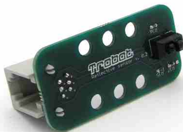
Rys. 114. Odbiciowy czujnik światła z zestawu SZM
