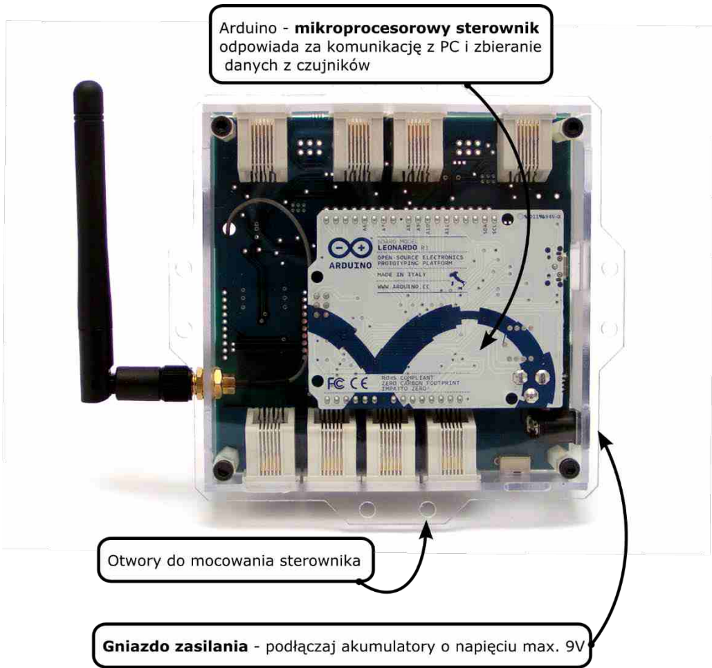
Rys. 68. Sterownik programowalny zestawu SZM widziany z dołu
