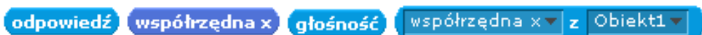
Rys. 31. Bloczki o takim kształcie nie są instrukcjami – nie łączą się ze sobą tworząc skrypt, ale za to przechowują dane, których potrzebują instrukcje. Umieszczasz je w białych polach innych instrukcji
