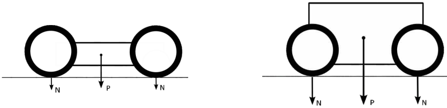
Rys. 131. Nacisk na koła zależy od ciężaru robota
