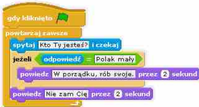
Rys. 38. Program żądający hasła i sprawdzający jego poprawność
