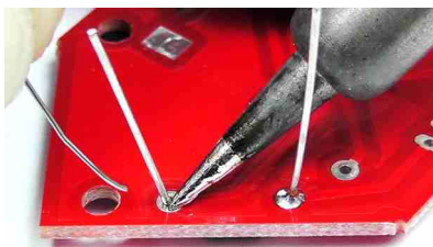
Rys. 103. Nagrzewanie końcówki elementu i pola lutowniczego
