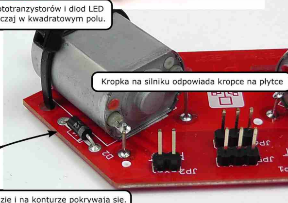
Rys. 106. Oznaczenia na płytce ułatwiające właściwy montaż elementów
