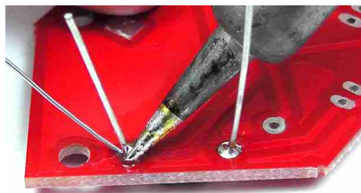
Rys. 104. Topienie cyny na polu lutowniczym
