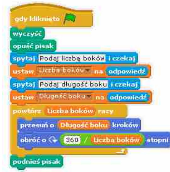
Rys. 54. Program rysujący wielokąt, wykorzystujący dwa argumenty
