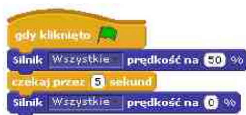
Rys. 71. Program uruchamia wszystkie silniki robota na 5 sekund
