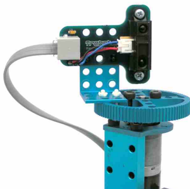
Rys. 123. Przykładowy sposób umocowania czujnika odległości
