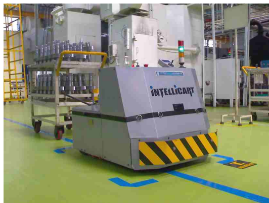
Rys. 113. Robot transportowy wykorzystujący do nawigacji kolorową linię. Autor: Mukeshhrs/Wikimedia Commons
