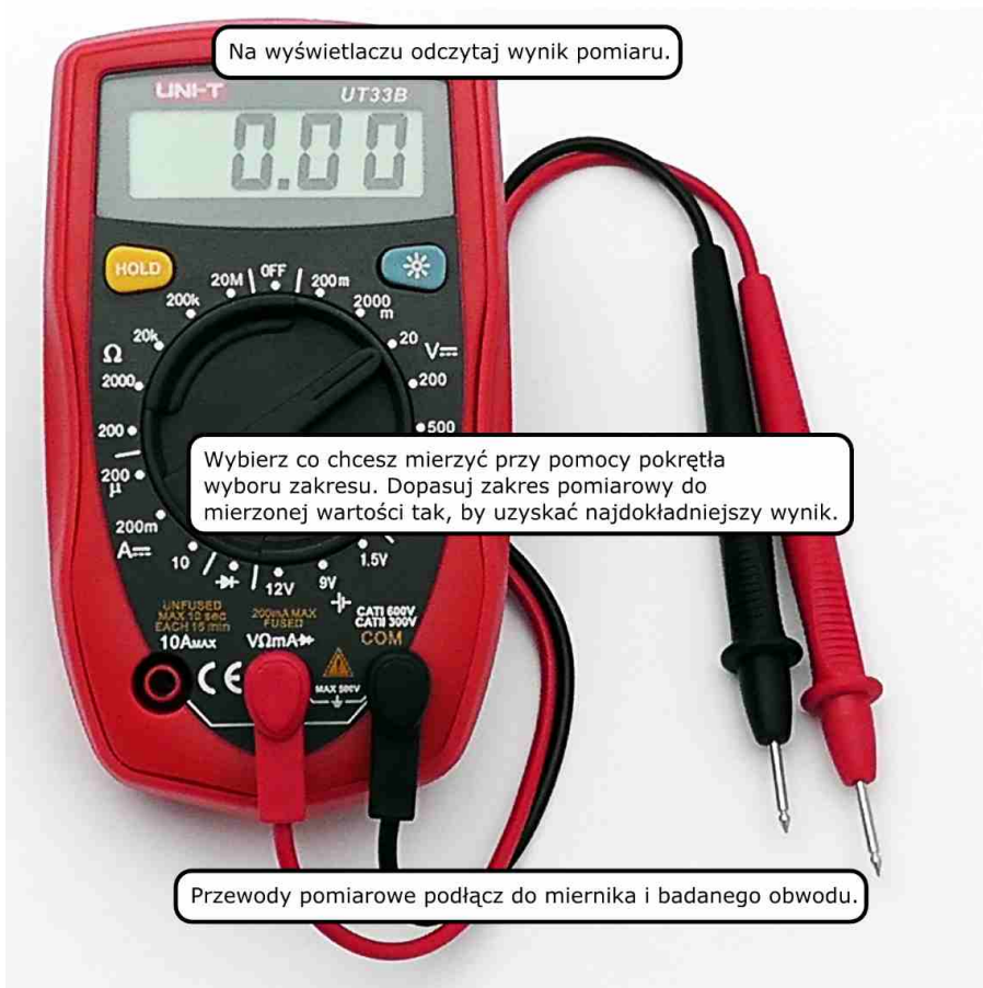
Rys. 98. Miernik uniwersalny, przygotowany do pomiaru napięcia stałego o wartości do 20V
