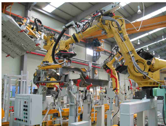
Rys. 112. Roboty przemysłowe na linii montażu samochodów. Autor: Mixabest / Wikimedia Commons
