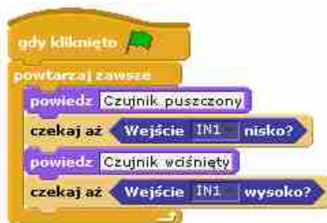
Rys. 119. Program reagujący na naciśnięcie czujnika dotyku
