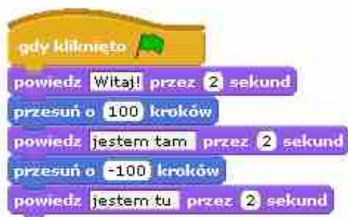
Rys. 16. Komenda "przesuń" zmienia położenie obiektu na scenie
