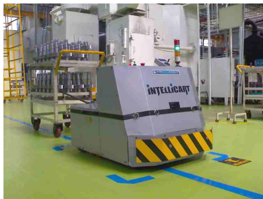
Rys. 109. Robot transportowy wykorzystujący do nawigacji kolorową linię. Autor: Mukeshhrs/Wikimedia Commons
