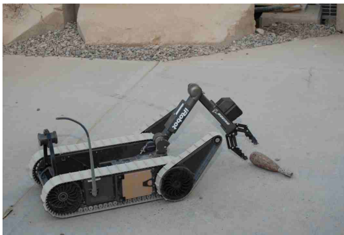
Rys. 122. Robot PackBot używany między innymi do badania skutków awarii w elektrowni Fukushima. Tutaj, podczas misji saperskiej. Autor: US Army / Wikimedia Commons
