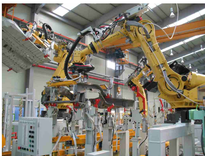
Rys. 108. Roboty przemysłowe na linii montażu samochodów. Autor: Mixabest / Wikimedia Commons
