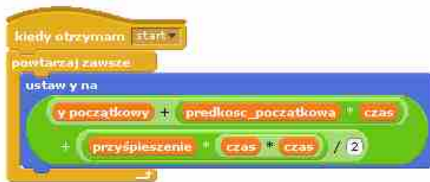
Rys. 72. Skrypt ruchu jednostajnie przyspieszonego w osi y. Położenie obiektu w osi x nie zmienia się.
