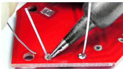
Rys. 81. Nagrzewanie końcówki elementu i pola lutowniczego
