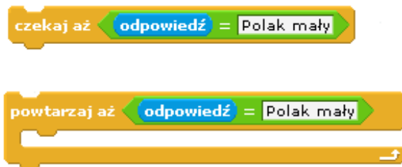
Rys. 42. Instrukcja "czekaj aż" powoduje wstrzymanie działania skryptu dopóki warunek nie zostanie spełniony. Jej działanie jest podobne do użycia pustej pętli "powtarzaj aż..."
