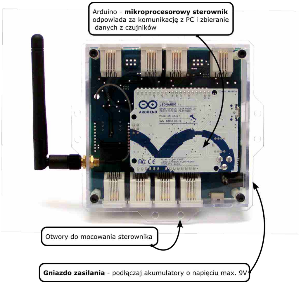
Rys. 92. Sterownik programowalny zestawu SZM widziany z dołu
