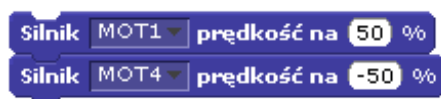
Rys. 97. Prędkość silnika może przyjmować wartości dodatnie i ujemne, zmieniając tym samym kierunek obrotów silnika
