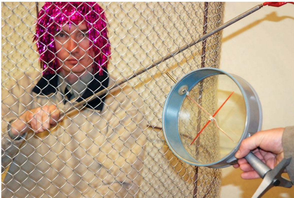
Klatka Faraday'a rzeczywiście ekranuje pole elektryczne – włosy nie stroszą się
