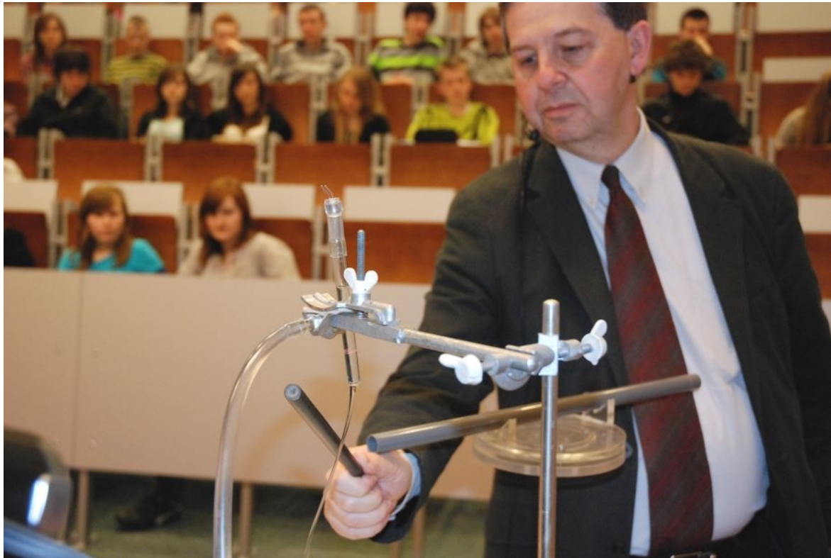
Naelektryzowany pręt ebonitowy silnie odchyła strumień wody
