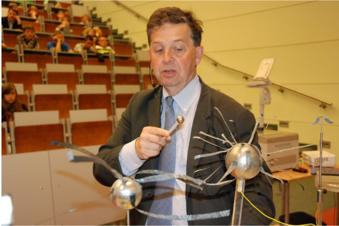
Pola elektryczne naładowanych kulek dobrze obrazują przyklejone cienkie paski folii
