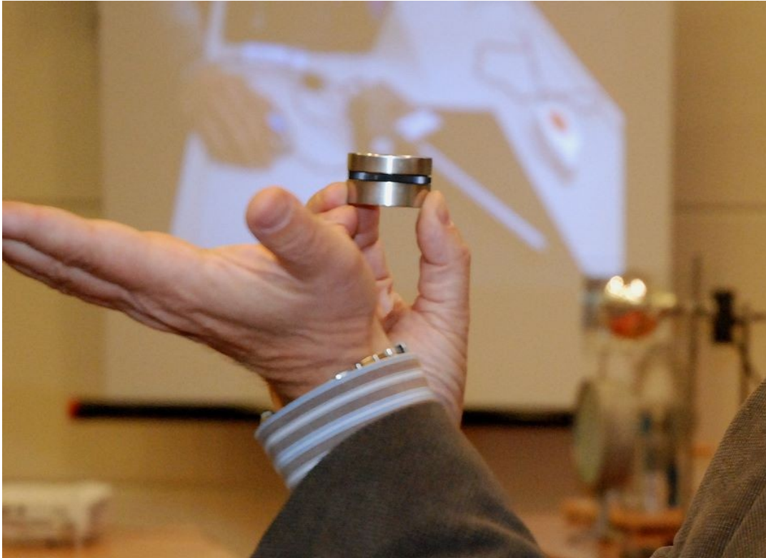
Oto źródło ^{241}\text{Am} promieniowania \alpha wzbudzające wtórnie promieniowanie X
