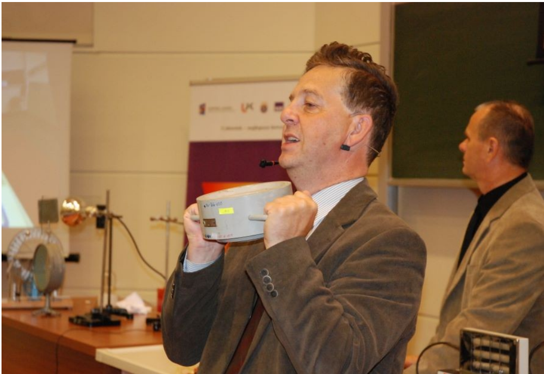
To nie gimnastyka tylko demonstracja grubej osłony ołowianej pochłaniającej promieniowanie
