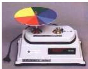
Rys.11.3 Krażek Newtona umieszczony na wirownicy.
