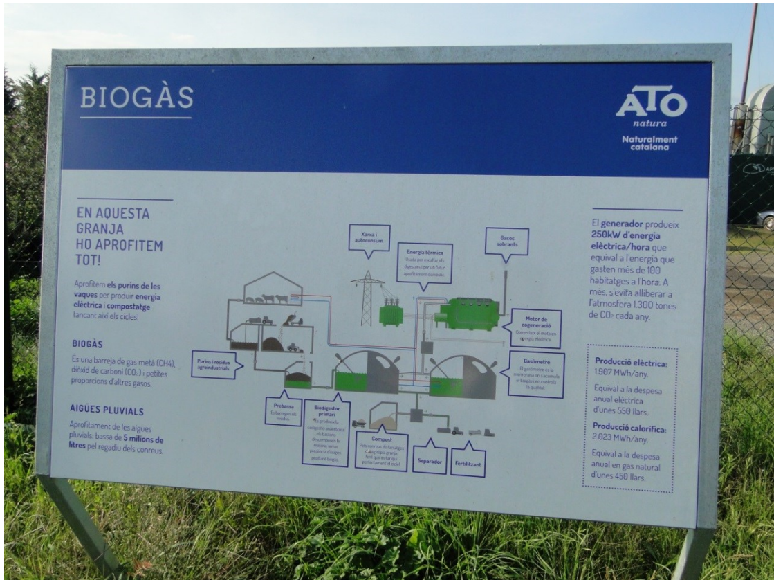
System pozyskiwania energii elektrycznej z odpadów bydła w firmie Mas Bes.
