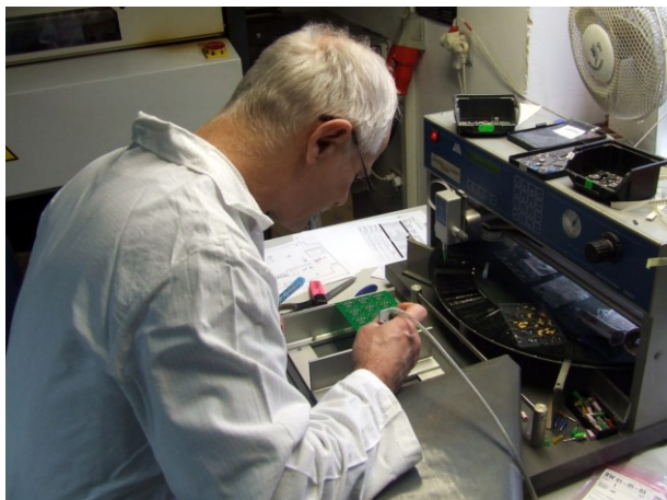
Ręczny montaż elementów
