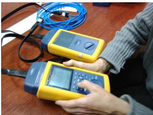
Pomiary parametrów okablowania strukturalnego
