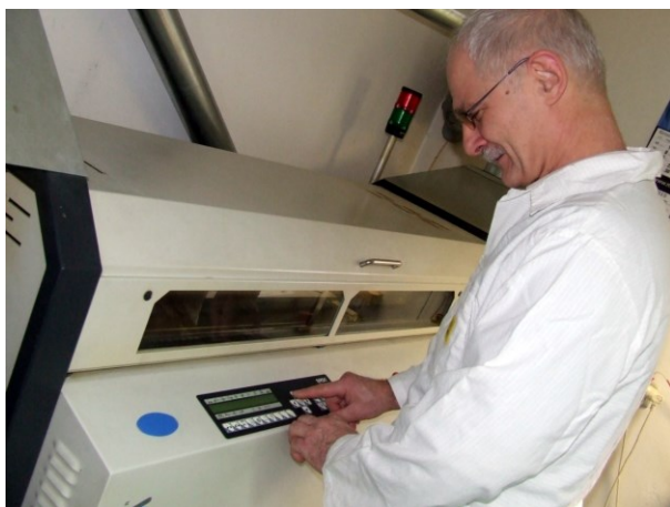
Spajanie elementów w piecu
