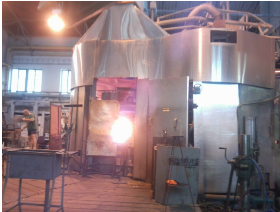
Piec do wykonywania wyrobów szklanych w Ruckl Crystal
