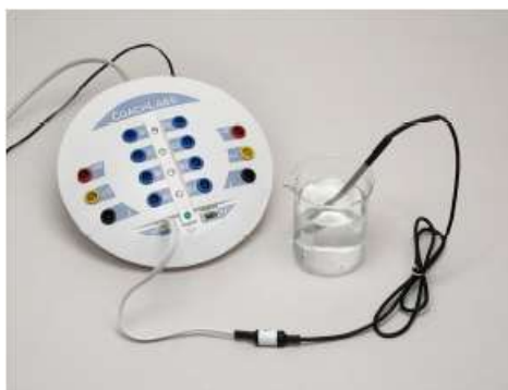
Rys. 1. Układ elektryczny do pomiaru temperatury wody.
