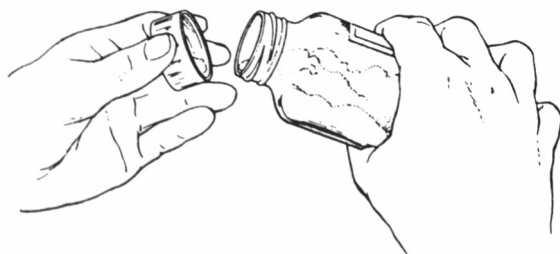
Rys. 9 b. Ostrożnie odkręć zakrętkę tak aby część odczynnika pozostała w niej
