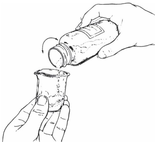
Rys. 11. Obracaj i potrząśnij słoikiem z odczynnikiem, aż pobierzesz potrzebną ilość odczynnika
