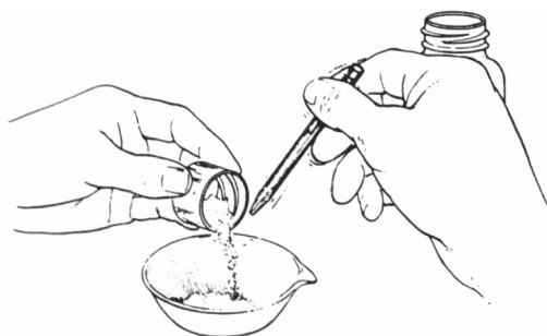
Rys. 9 c. Uderzaj w zakrętkę ołówkiem lub palcem do czasu aż pobierzesz odpowiednią ilość odczynnika
