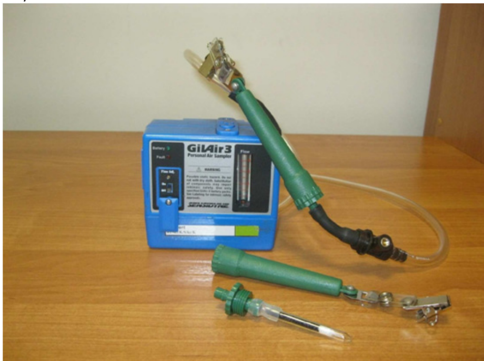
Rys.2 Zestaw do pomiaru związków lotnych
