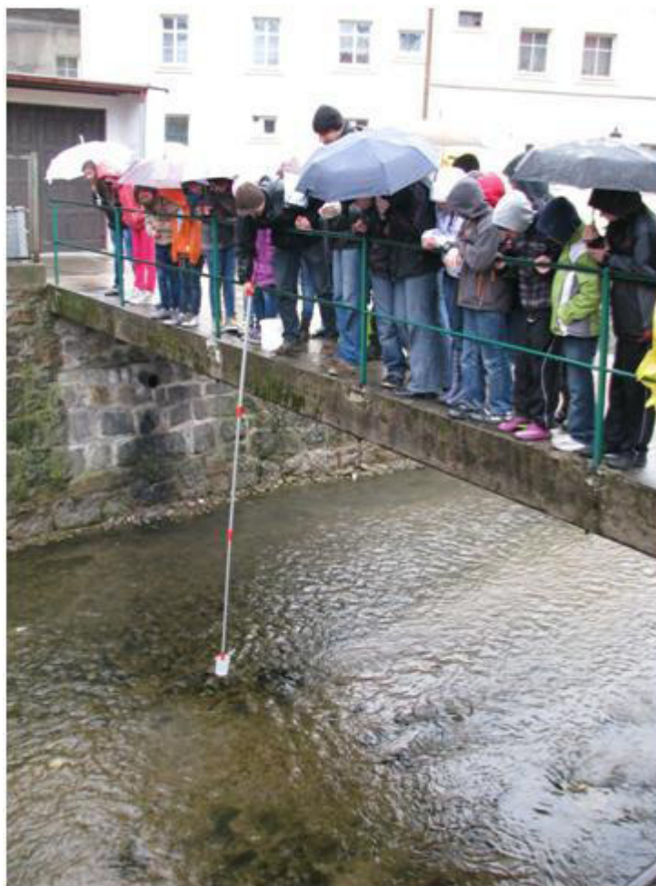
Rys. 2 Pobór próbek wody powierzchniowej w szkole przy użyciu czerpaka.
