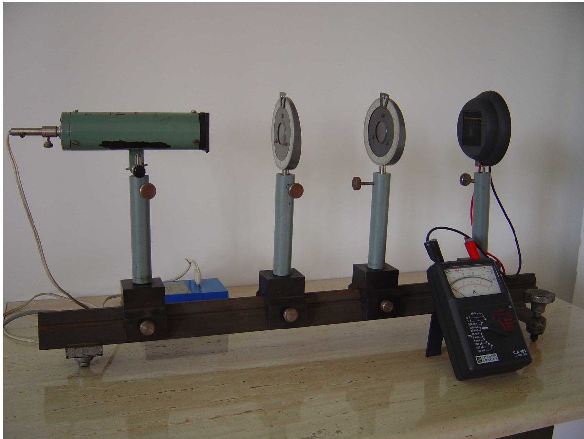
Fot. 2. Zestaw do wyznaczania zależności natężenia wiązki światła, przechodzącego przez układ polaryzator-analizator, od kąta skręcenia polaryzatora
