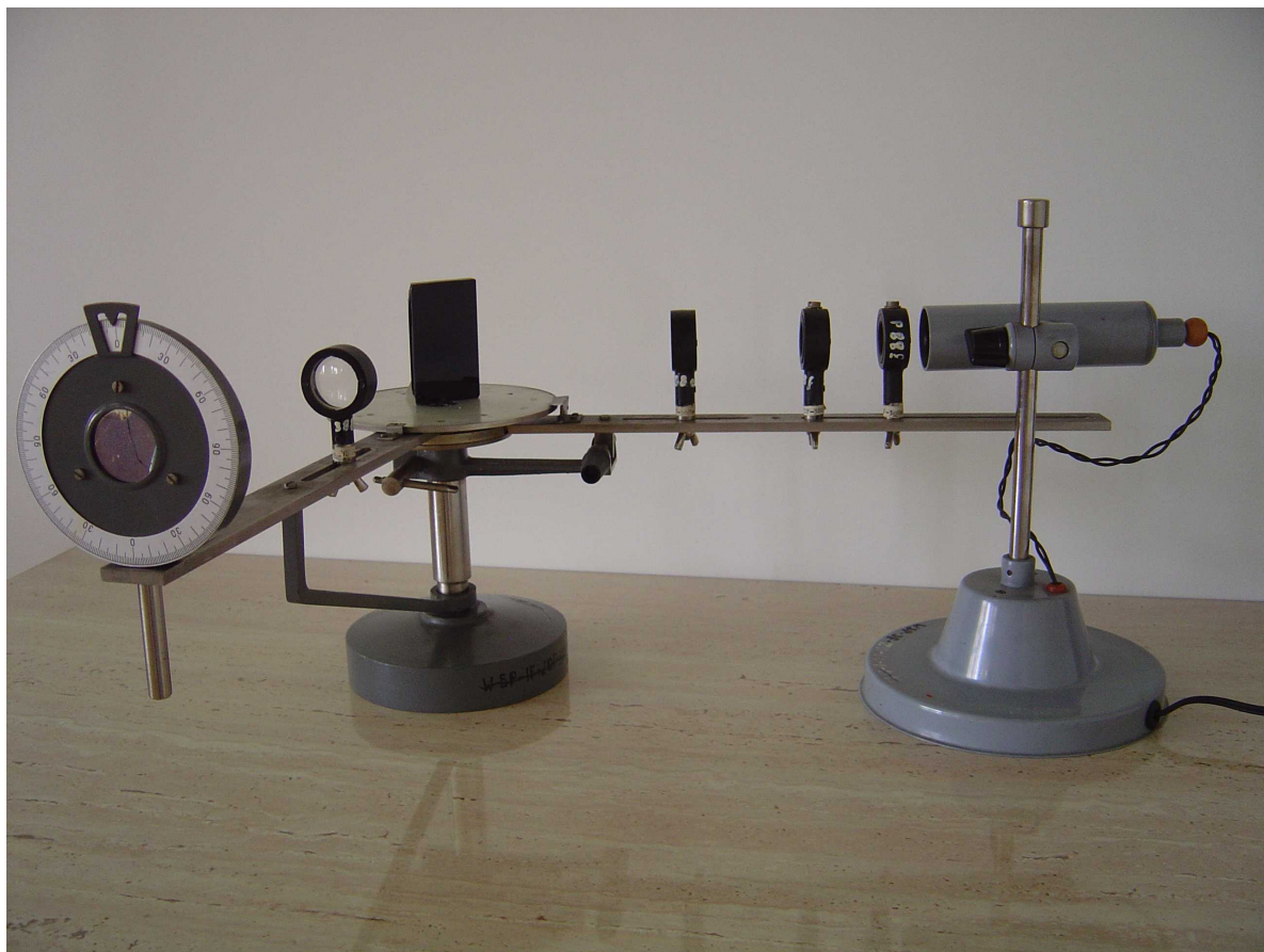
Fot.3. Zestaw do wyznaczenia kąta Brewstera.
