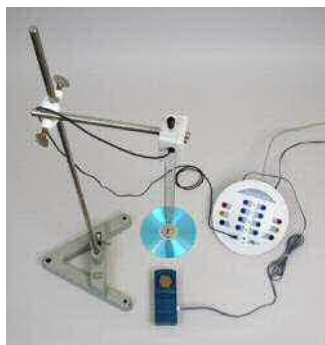
Rysunek 3. Zestaw doświadczalny. Wahadło sprężynowe zawieszono na czujniku siły, UDR pod wahadłem.
