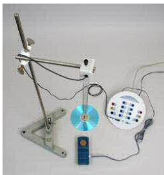
Rysunek 3. Zestaw doświadczenia. Wahadło sprężynowe zawieszono na czujniku siły, UDR pod wahadłem.
