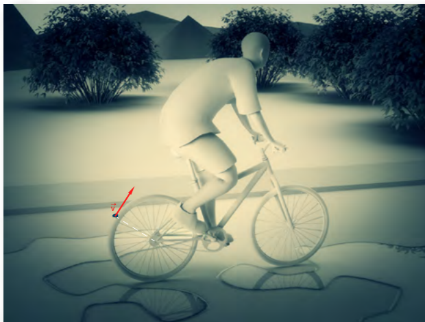
Rys. 1.6. Chwilowy kierunek prędkości kawałka błota przylepionego do opony koła rowerowego.
