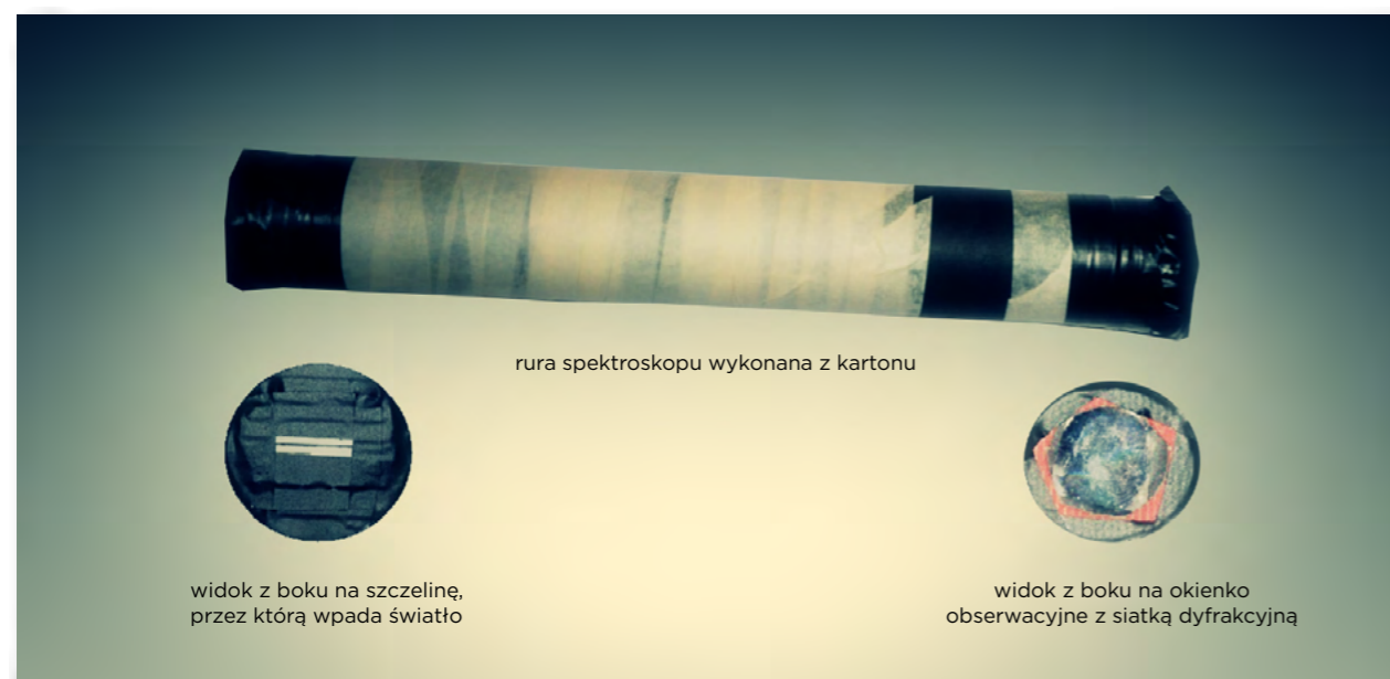
Rys. 2.10. Samodzielnie wykonany spektroskop do badania widm świecących ciał.
