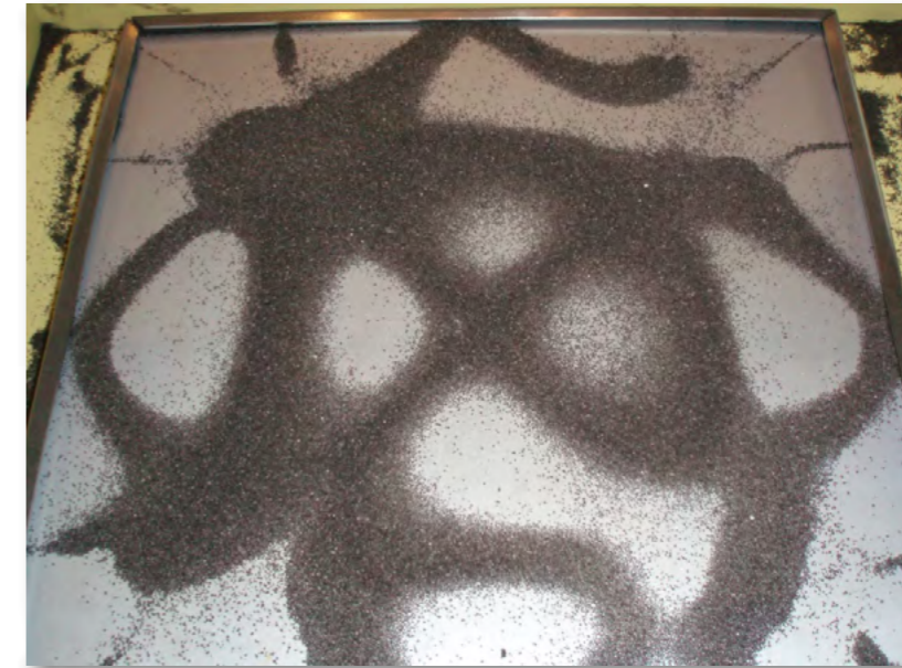
Rys. 7.5. Figury Chladniego (zdjęcie wykonane przez autorkę w Centrum Nauki Kopernik).
