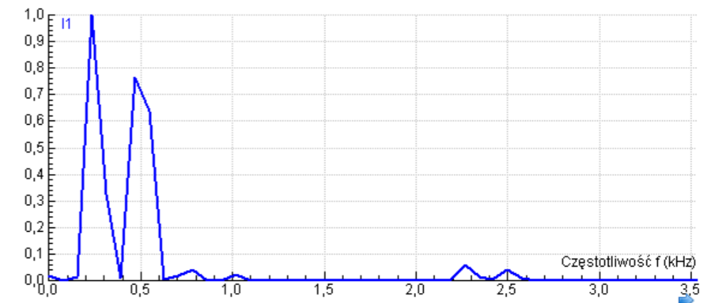
Rys.8.3. Widmo dźwięku „e” zawiera dwie główne składowe o częstotliwościach: 0,23 kHz i 0,46 kHz.
