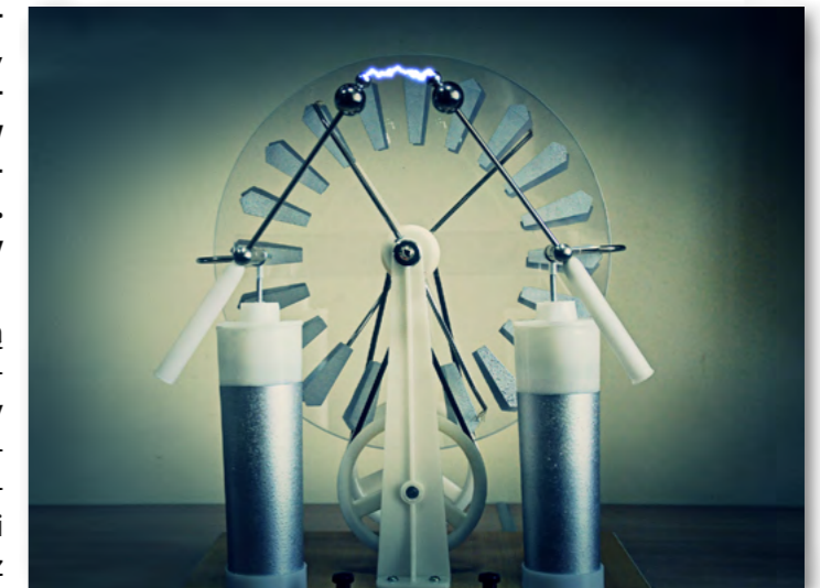
Rys. 9.18. Przeskok iskry między kulkami maszyny elektrostatycznej.
