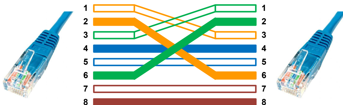
Rysunek 7. Przykład zaterminowania kabla krosowego według normy EIA/TIA 568B
