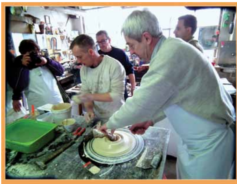
Wykonywanie małej, okrągłej rozety metodą ciągnoną
