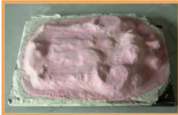
Forma silikonowa nałożona na gipsowy model, czeka na wykonanie kapy usztywniającej miękkiego silikonu
