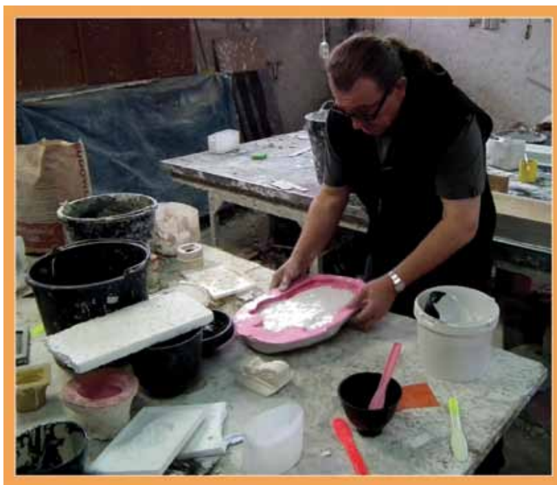
Wykonywanie małego odlewu w pracowni sztukatorskiej
