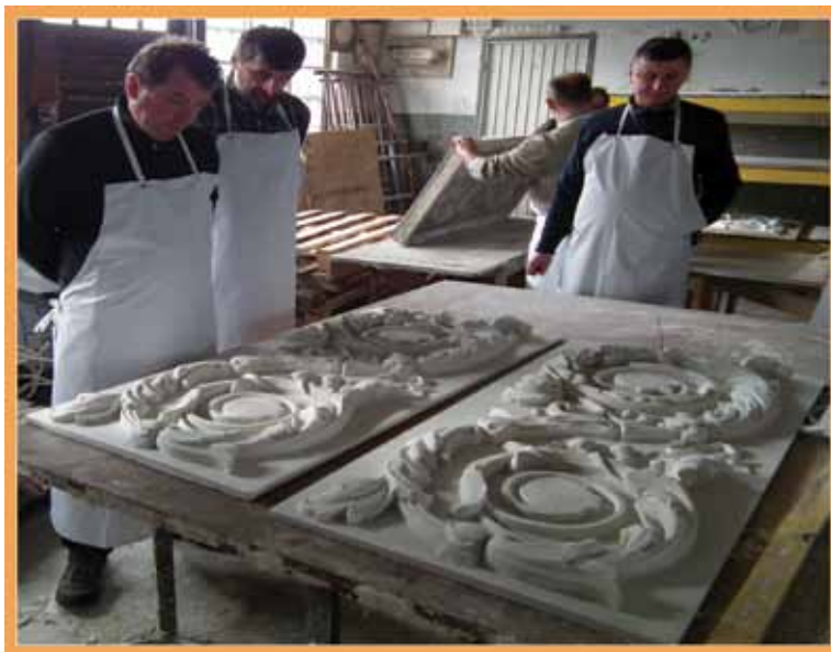
Produkcja ozdobnych paneli z gipsu w pracowni sztukatorskiej
