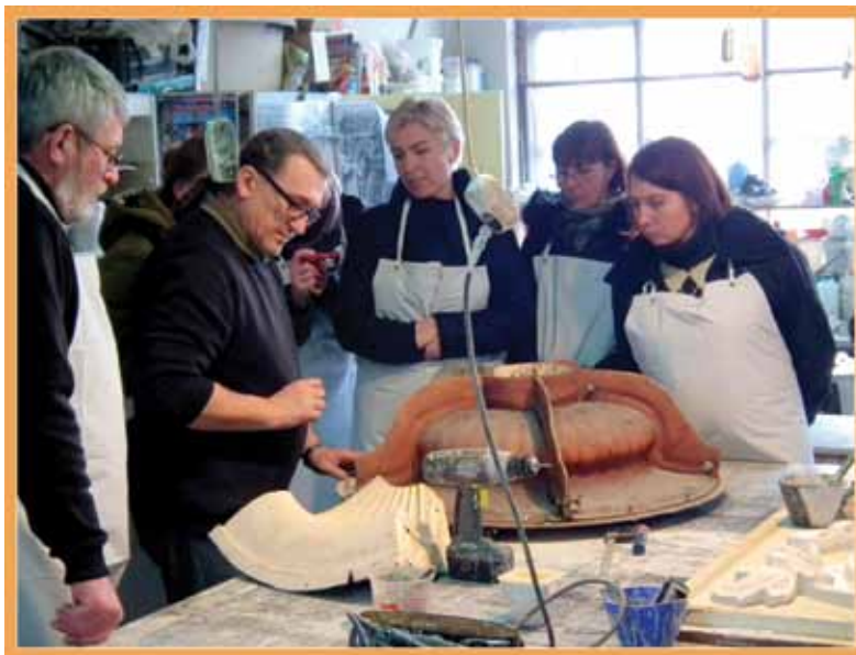
Prezentacja współczesnej formy klinowej, wykonanej z laminatu przy użyciu żywicy epoksydowej
