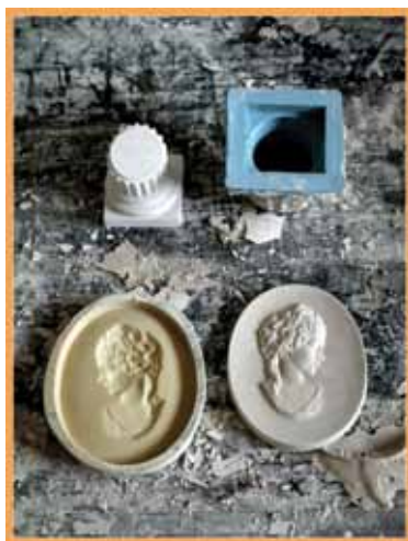
Dwie formy silikonowe i wykonane w nich odlewy z gipsu sztukatorskiego
