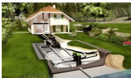
Przykład przydomowej oczyszczalni ścieków
