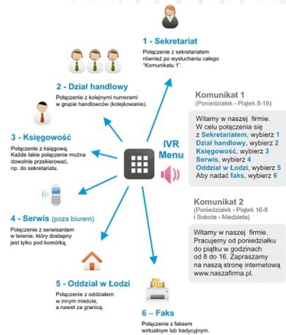
Schemat centrali telefonicznej HaloNet
