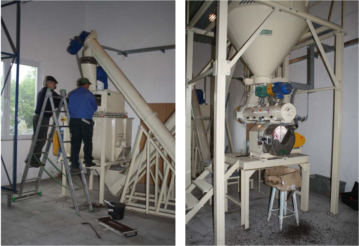
Fot. 2 . Linia do granulacji materiałów organicznych (zdjęcie Wydziałowa Stacja Doświadczalna w Skierniewicach)
