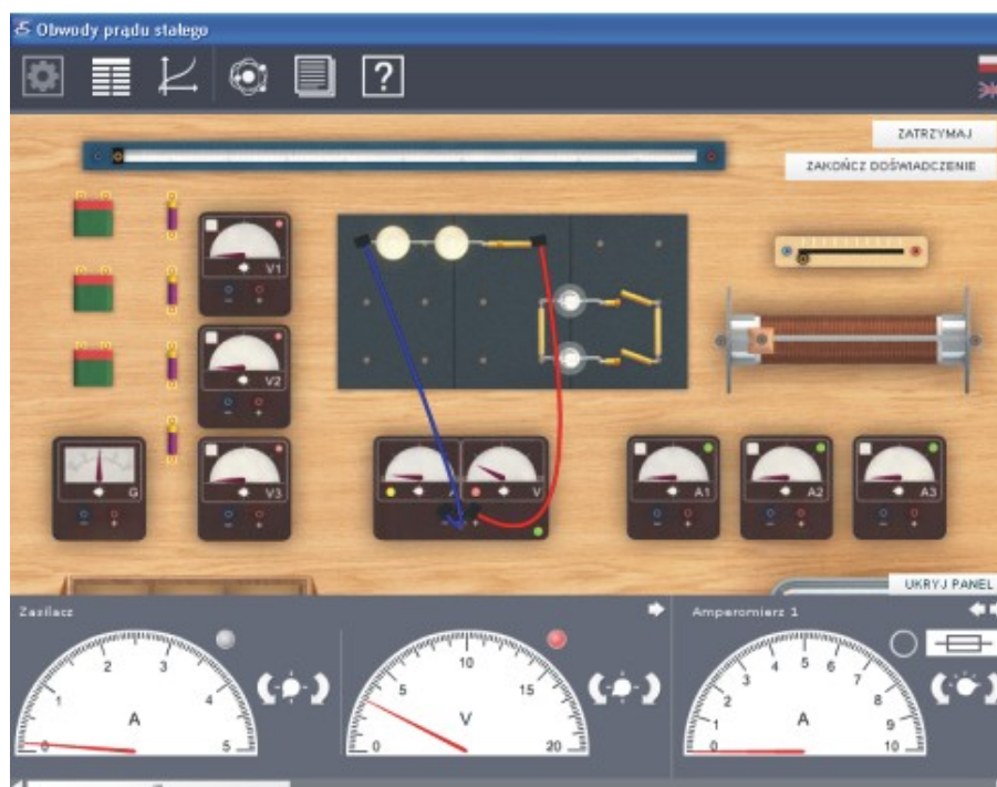
Rys.1. Widok okna głównego e-doświadczenia „Obwody prądu stałego”. U dołu znajduje się przewijany panel z powiększonymi skalami urządzeń i mierników.
