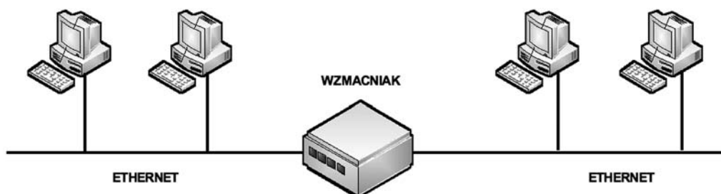
Rysunek 14. Przykład zastosowania wzmacniaka
