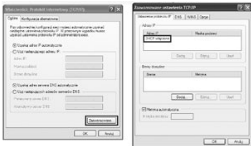
Rysunek 23. Efekt wybrania zakładki Zaawansowane w oknie Właściwości Protokołu internetowego TCP/IP
