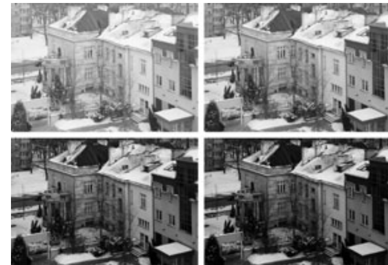
Rysunek 6. Efekt zastosowania korekcji gamma, lewy górny róg – obraz oryginalny, pozostałe obrazy są wynikiem zastosowania korekcji gamma z różnym współczynnikiem \gamma
