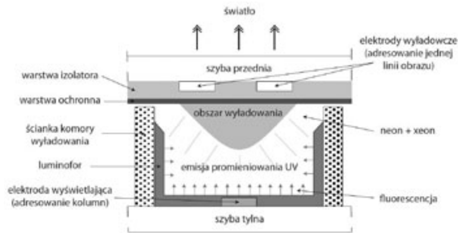
Rysunek 26. Konstrukcja pojedynczego piksela wyświetlacza plazmowego
