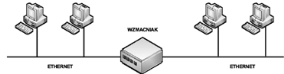
Rysunek 14. Przykład wykorzystania wzmacniaka w sieci
