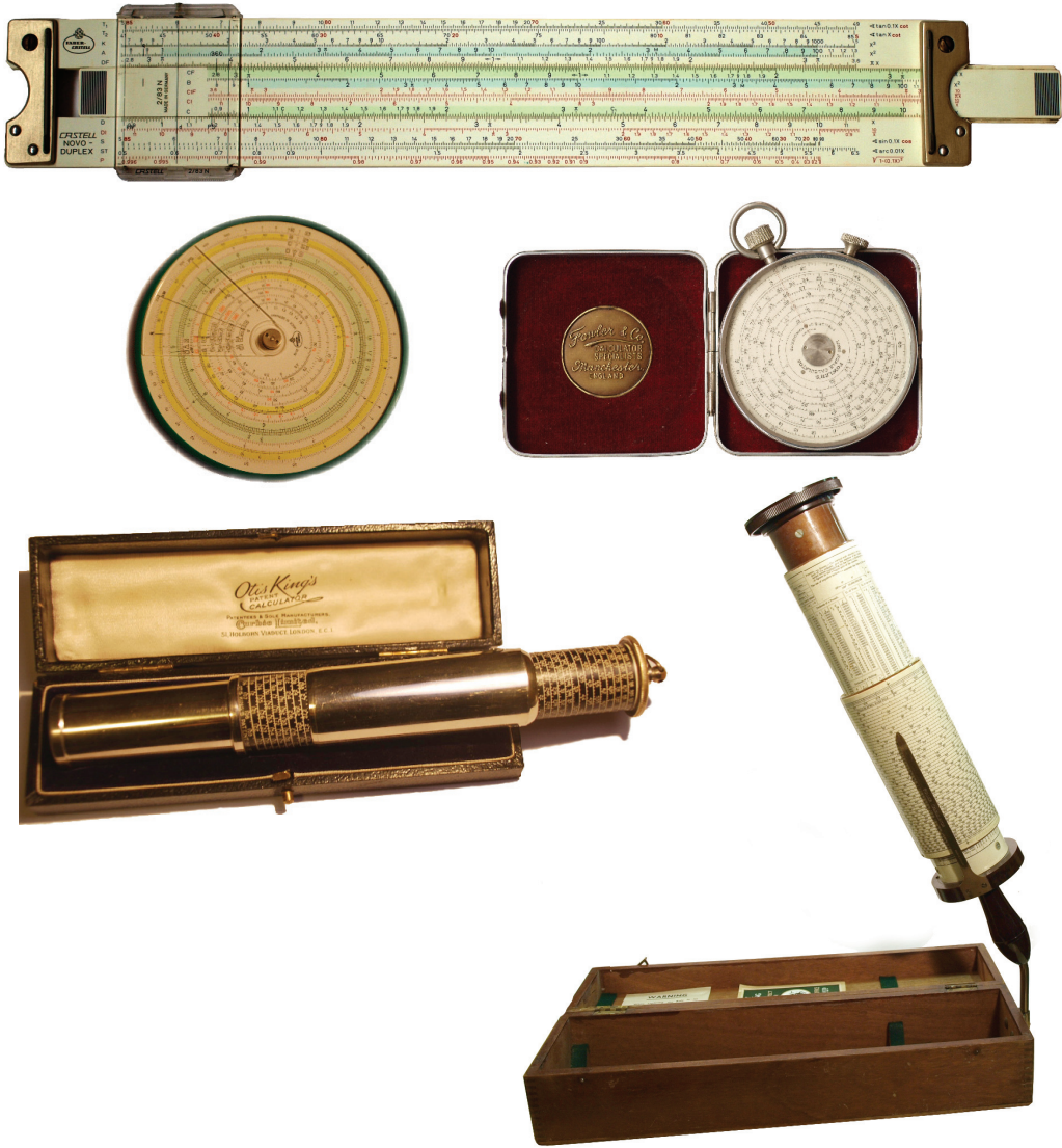
Rysunek 17. Przykłady suwaków logarytmicznych: liniowy, kołowy, w postaci zegarka (Fowlers), cylindryczny (Otis King – długość skali 1,5 m) i na walcu (Fuller – długość skali 12 m)
