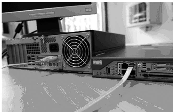
Rysunek 7. Przykład połączenia komputera (terminala) do portu konsoli routera
