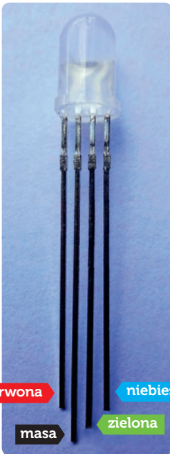
opis wyprowadzeń diody RGB ze wspólną katodą
