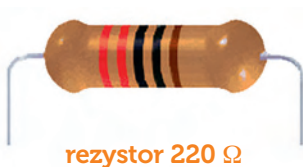
oznaczenie kodem barwnym rezystora 220 \Omega
